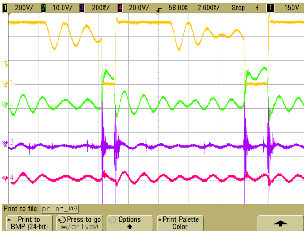
Obr. 45 „Quasi-resonant mode“, spínací kmitočet 116 kHz ( V_{out}=19,4 V; I_{out}=5,6 A)
