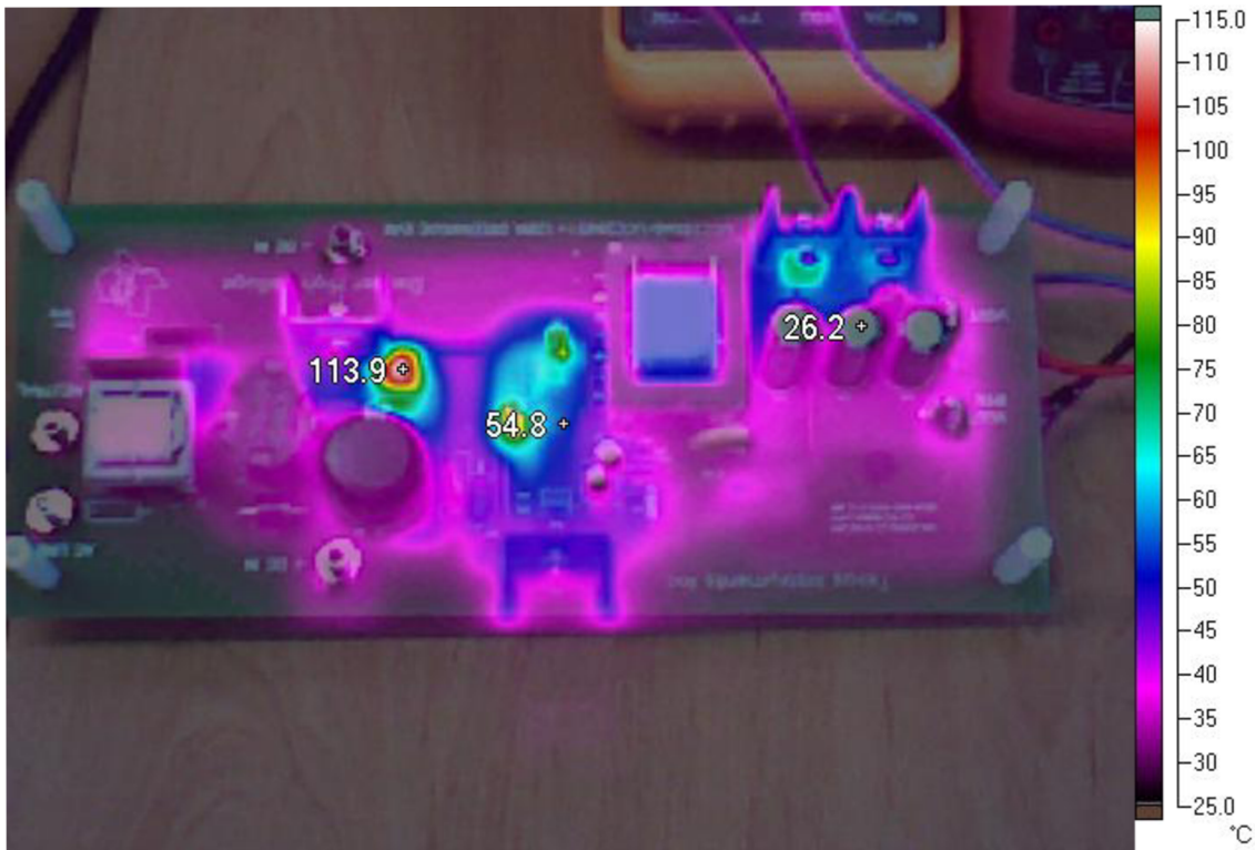
Obr. 46 Referenční TI zdroj při zatížení 100 % po uplynutí 3 minut
