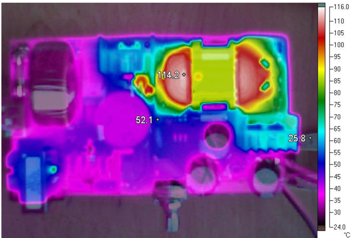
Obr. 49 Vlastní prototyp při zatížení 100 % po uplynutí 10 minut
