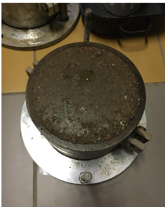
Obrázek 3.16 - Zkušební vzorek po saturaci
