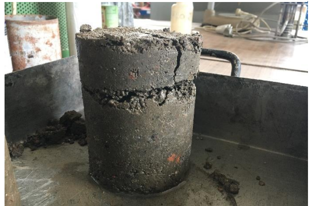
Obrázek 3.21 - Vzorek z RSM kamenitého po zkoušce
