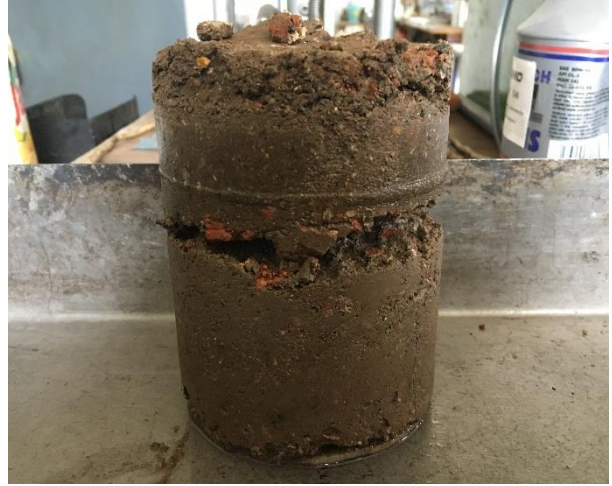
Obrázek 3.22 - Vzorek z RSM cihelného po zkoušce
