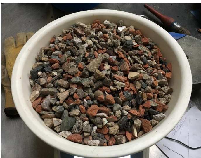
Obrázek 3.23 - Promytý a vysušený zkušební vzorek
