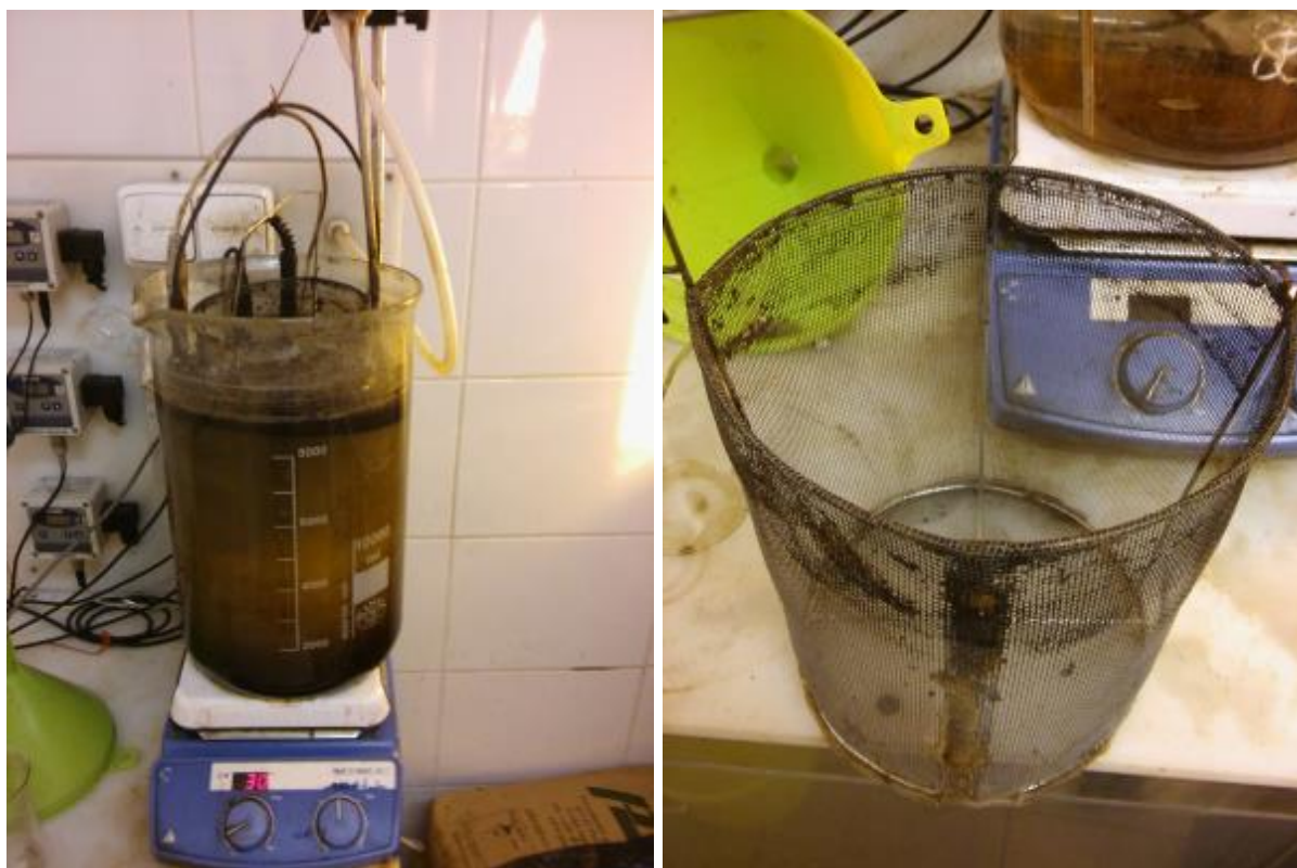
Obrázek 3. Přístroj pro vyluhování vermikompostů s kovovým sítím, systémem provzdušňování a magnetickým míchadlem, sondami pro měření teploty, pH, množství O 2 a EC a udržováním konstantní teploty 30 °C. Foto: autorka.
