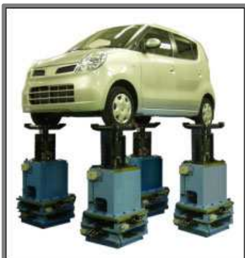
Obr. 2-7 Štvorbodový vibračný tester [13]
