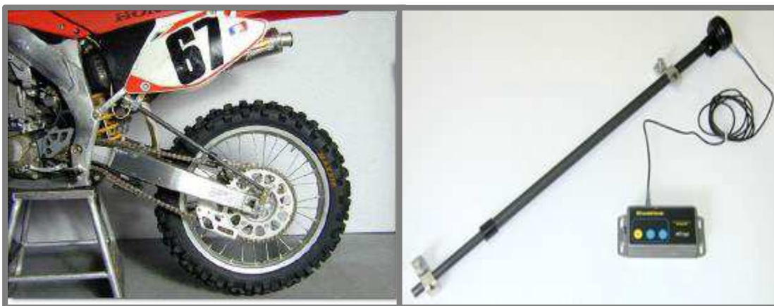
Obr. 2-15 Umiestnenie potenciometra pre BD [17] Obr. 2-16 Potenciometer pre BD [18]
