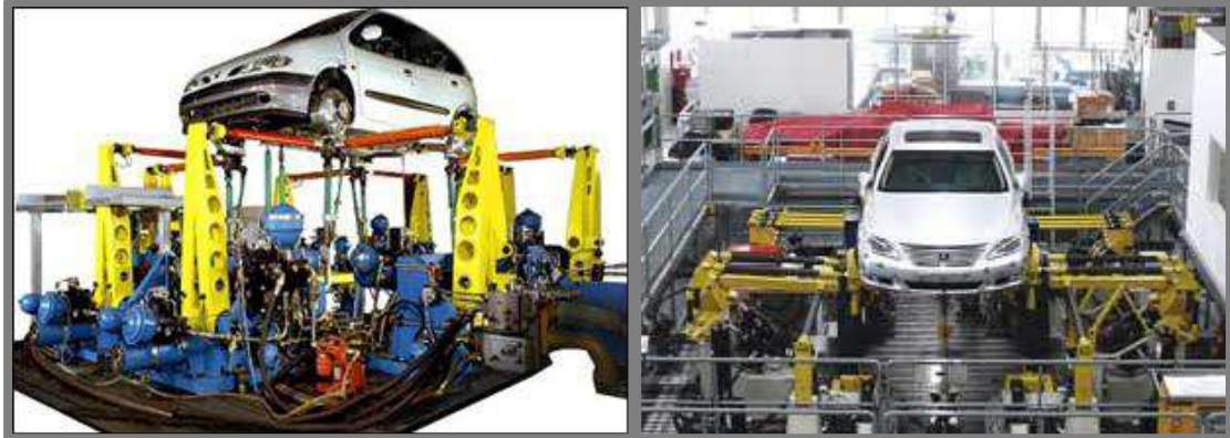
Obr. 2-12 Štvorkolesový simulátor vozovky [11] Obr. 2-13 Štvorkolesový simulátor vozovky [14]
