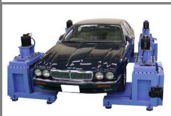
Obr. 2-8 Štvorbodový vibračný tester [21]
