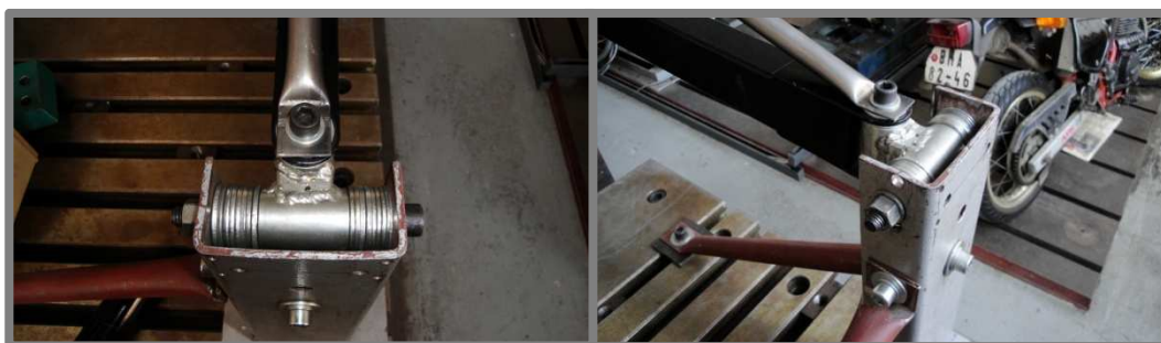
Obr. 3-3 Naklápanie vozíka pred rekonštrukciou
