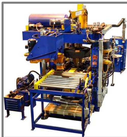
Obr. 2-1 Tester vyváženia pneumatík osobných automobilov [8]
