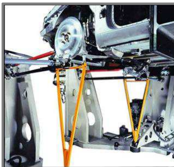
Obr. 2-11 Simulátor vozovky na kontrolu riadenia [11]
