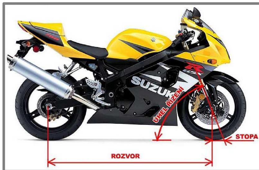
Obr. 3-1 Parametre uloženia tlmiacej jednotky [19]
