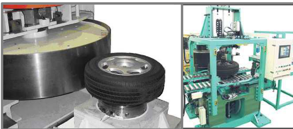
Obr. 2-2 Tester nerovností v pneumatikách za vysokých rýchlostí [9] [20]
