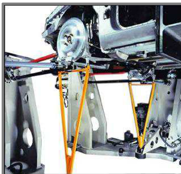
Obr. 2-11 Simulátor vozovky na kontrolu riadenia [11]
