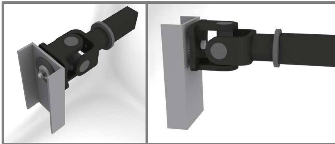
Obr. 8-2 Uchytenie kardanu na U-profil
