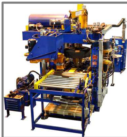
Obr. 2-1 Tester vyváženia pneumatík osobných automobilov [8]
