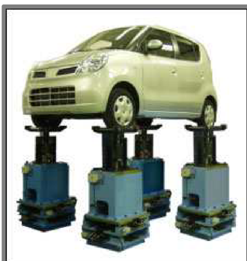
Obr. 2-7 Štvorbodový vibračný tester [13]
