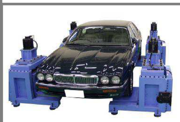
Obr. 2-8 Štvorbodový vibračný tester [21]
