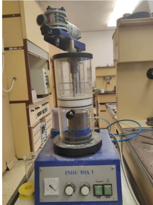
Obr. 22 Zařízení pro přípravu formovací směsi Indumix 1
