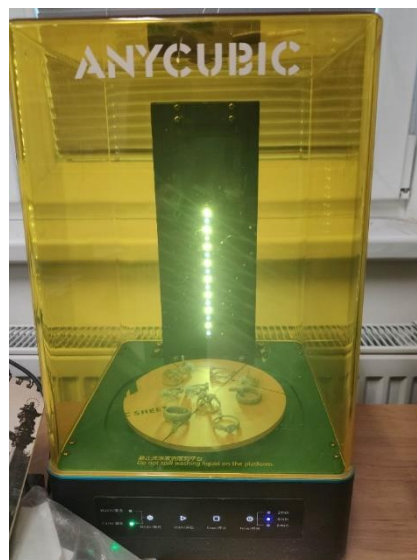
Obr. 18 Vytvrzování modelů pomocí ANYCUBIC Wash&Cure
