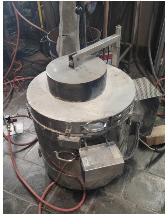
b) Pec využitá pro vytavování modelů
