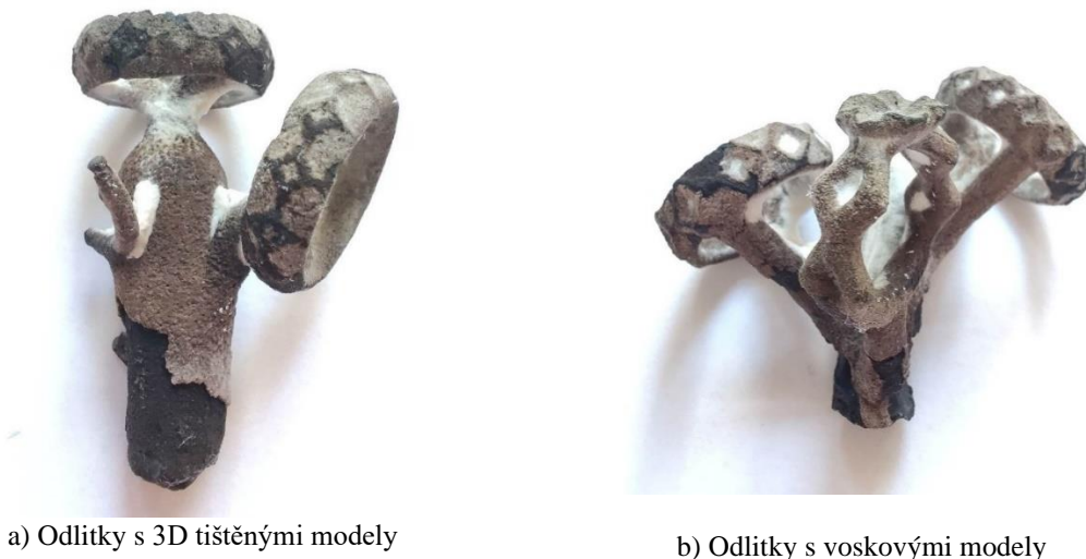
Obr. 27 Odlitky po odstranění sádry a před povrchovou úpravou
