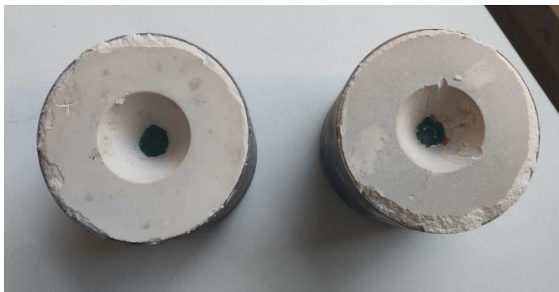
Obr. 23 Sádrové formy po odstranění gumové vtokové soustavy
