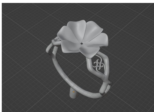
c) 2. model s jedním připojením vtokové soustavy
