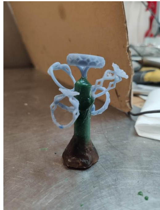
b) 3D tištěné modely sestavené do stromečku
