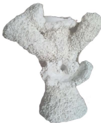
Obr. 33 Prasklá skořepina s 3D tištěnými modely
