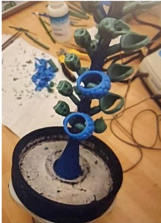
Obr. 12 Rozložení modelů do stromečku [19].
