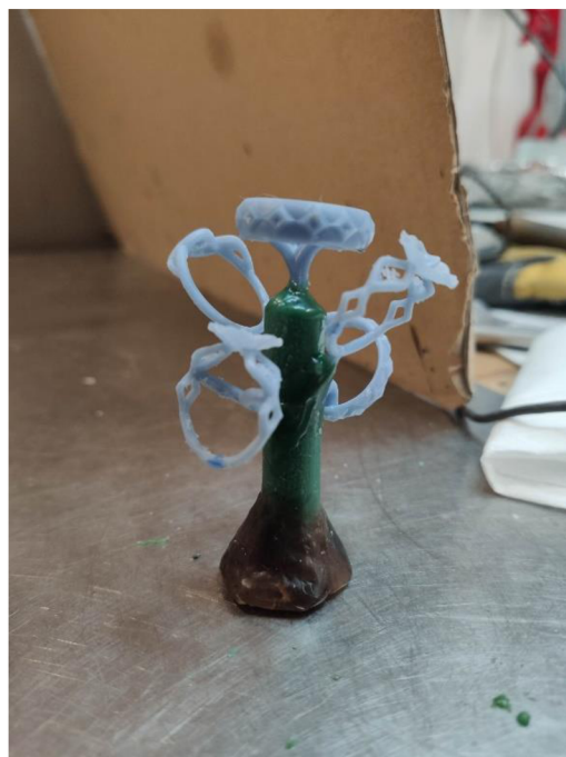
b) 3D tištěné modely sestavené do stromečku
