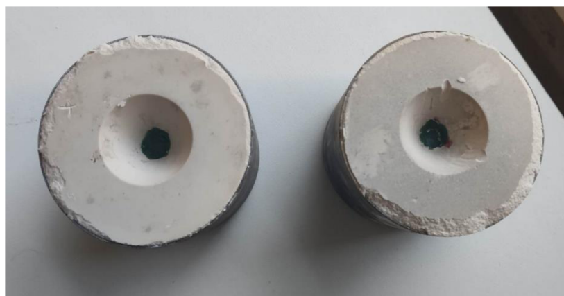
Obr. 23 Sádrové formy po odstranění gumové vtokové soustavy
