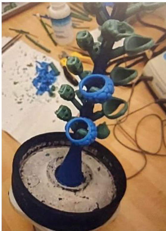
Obr. 12 Rozložení modelů do stromečku [19].
