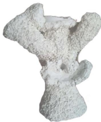
Obr. 33 Prasklá skořepina s 3D tištěnými modely
