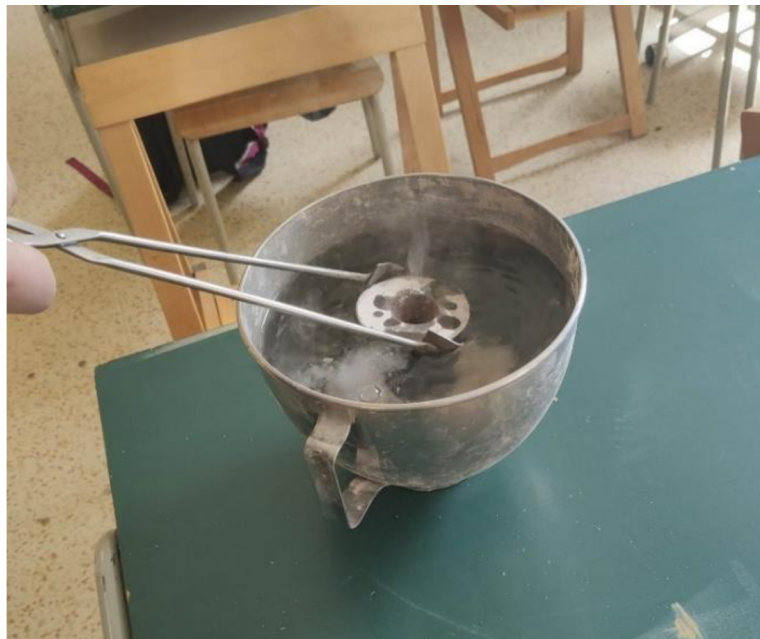
Obr. 26 Odstranění sádrové formy po odlití
