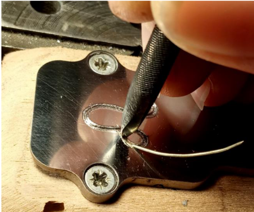
Obr. 8 Zaklepávání měkčího kovu pomocí čakanu [11]
