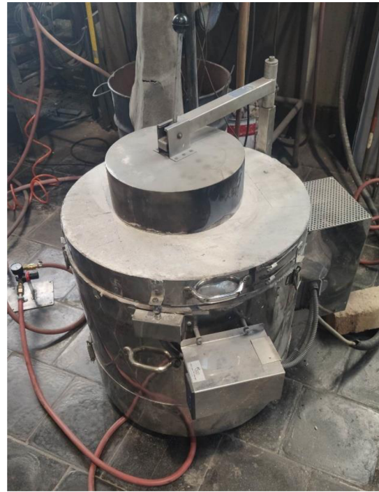
b) Pec využitá pro vytavování modelů
