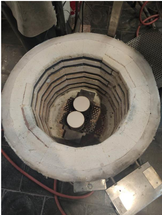
a) Umístění forem v peci při vytavování modelu
