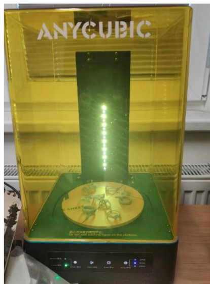
Obr. 18 Vytvrzování modelů pomocí ANYCUBIC Wash&Cure
