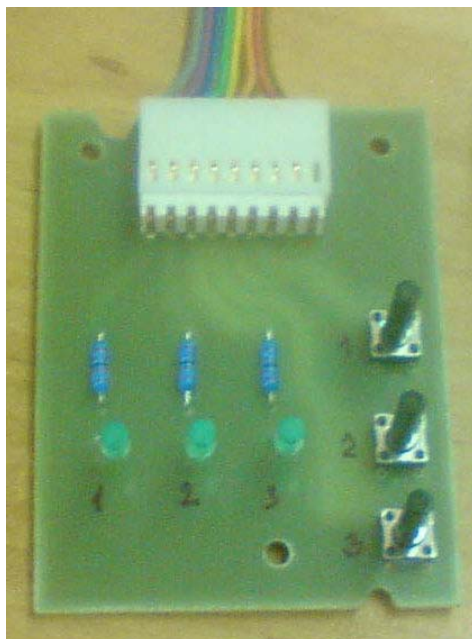
Obr. 29 Osazená deska představující vnitřní ovládací prvky kabiny
