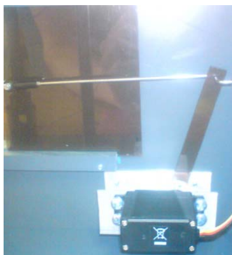
Obr. 13 Mechanismus otevírání dveří
