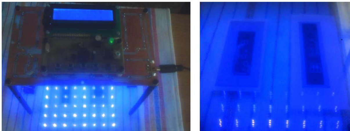
Obr. 32 Osvětlování fotocitlivé desky UV zářením
