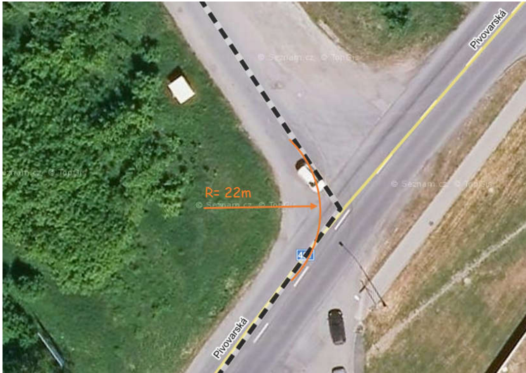
Obrázek č. 3 Vjezd od betonárky na hlavní silnici [1]
