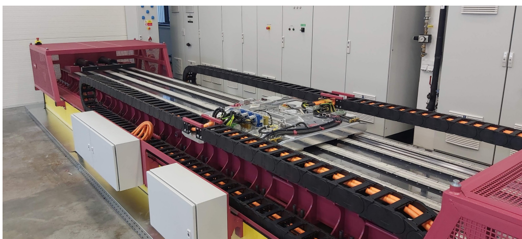
Obr. A.2: Lineární dynamometr (se zkoušeným motorem) pohled 2
