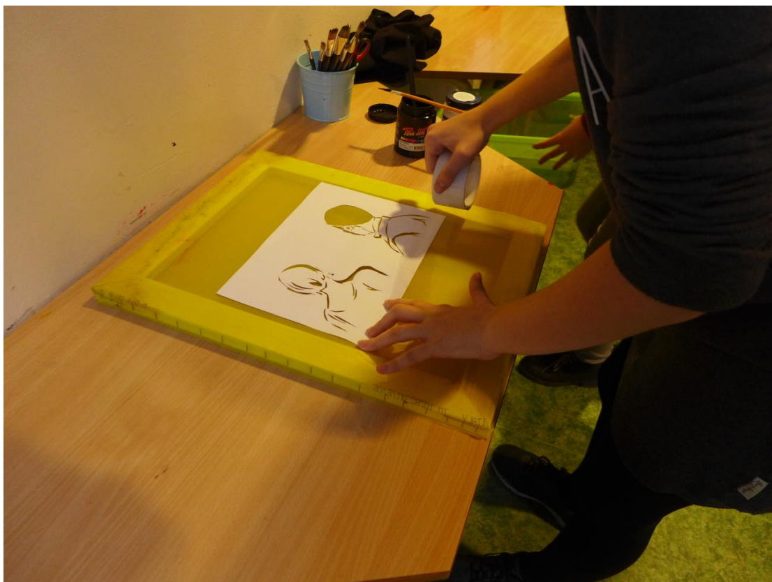
Obrázek 37: Práce s šablonou na sítotisk, která vznikla vyřezáním grafického přepisu snímku
