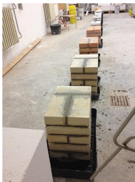
Obr. P11: Zdění zkušebních piliřů dle směrnice WTA 4-4-04/D
