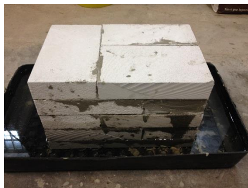
Obr. P12: Prostup vztlínající vlhkosti ve zděných pilířích (1. řádek – cihla plná pálená, 2. řádek – cihla pískovcová, 3. řádek – Pórobeton – klasické zdění, 4. řádek – pórobeton přesné zdění)
