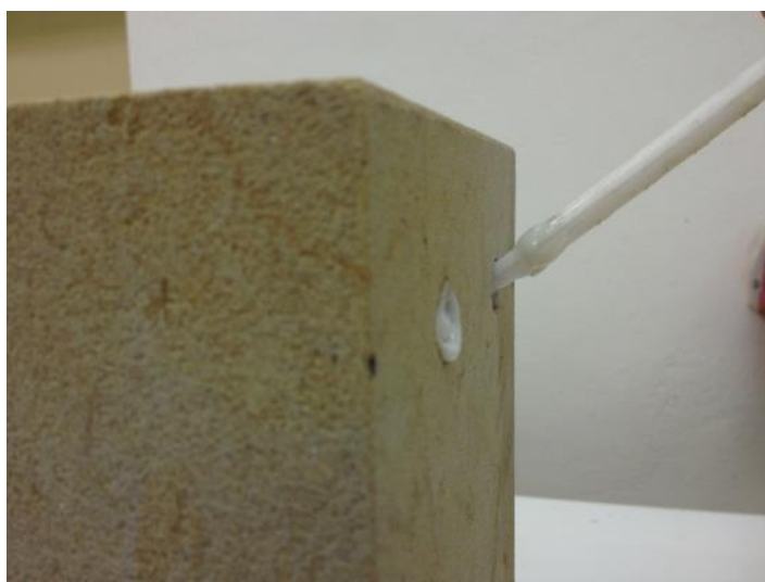
Obr. 64: Aplikace injektážního gelu A do zkušebního tělesa cihly pískovcové
