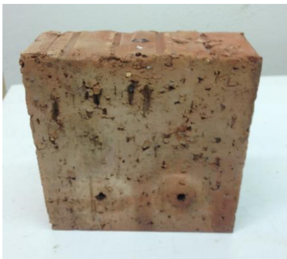
Obr. 65: Zkušební těleso cihly plné pálené injektované gelem C
