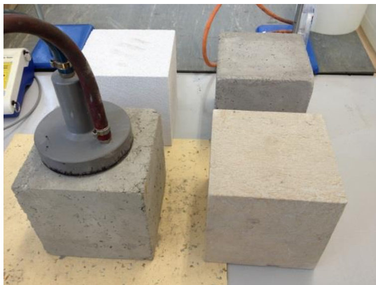
Obr. 62: Průběh měření vzduchové propustnosti metodou Torrent na pórobetonu, zdíci maltě 1, zdíci maltě 2 a cihle pískovcové
