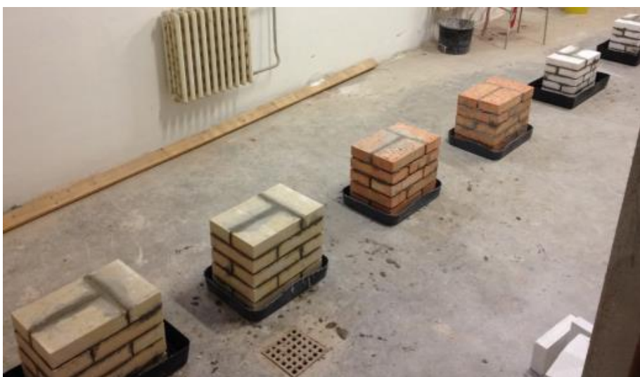
Obr. 76: Vyzdění zkušební pilíře (zprava: 2 pilíře cihly pískovcové, 2 pilíře cihly plně pálené a 2 pilíře pórobetonové s klasickým zděním)
