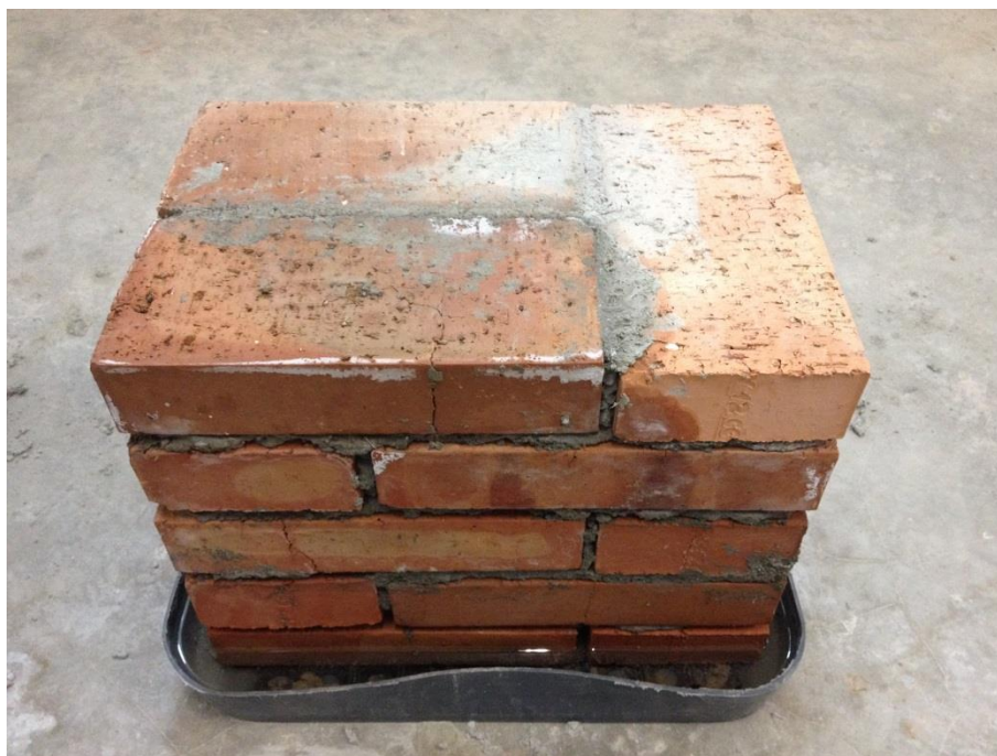
Obr. 79: Pilíř vyzděný z pálených cihel po 28 dnech působení vztlínající vlhkosti
