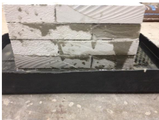
Obr. P12: Prostup vztlínající vlhkosti ve zděných pilířích (1. řádek – cihla plná pálená, 2. řádek – cihla pískovcová, 3. řádek – Pórobeton – klasické zdění, 4. řádek – pórobeton přesné zdění)
