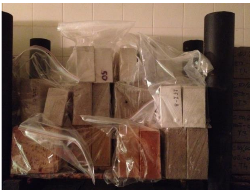
Obr. 66: Injektovaná tělesa v rámci provádění zkoušky míry penetrace infuzní clony za různých vlhkostí
