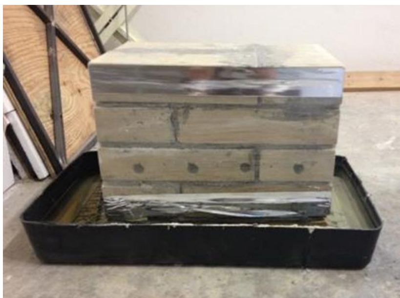
Obr. 82: Injektovaný pískovcový pilíř s izolovanými bočními stěnami
