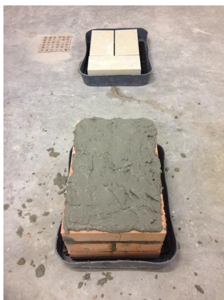
Obr. P11: Zdění zkušebních piliřů dle směrnice WTA 4-4-04/D
