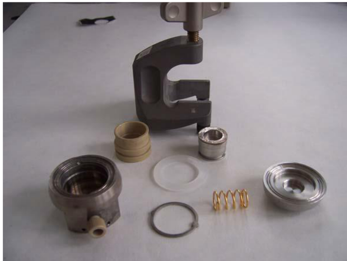
Obr. 17 – Rozobraná elektrochemická testovacia cela [12]
