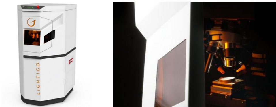
Obrázek č. 5: Měřicí sestava FireFly od firmy Lightigo a ablační komora s motorizovaným stolcem [70].
