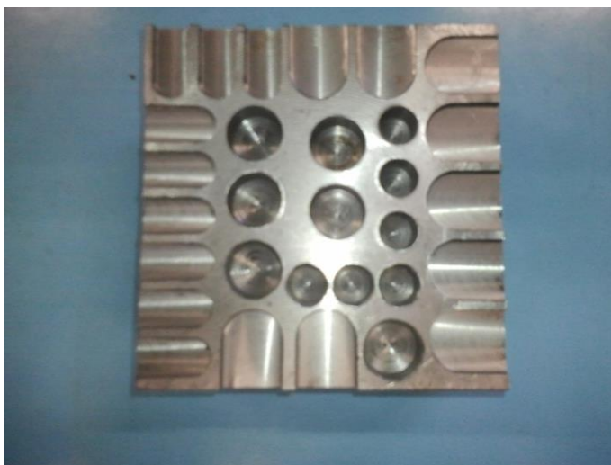
Obr.8 Obrobený polotvar s podstavou 95 mm
