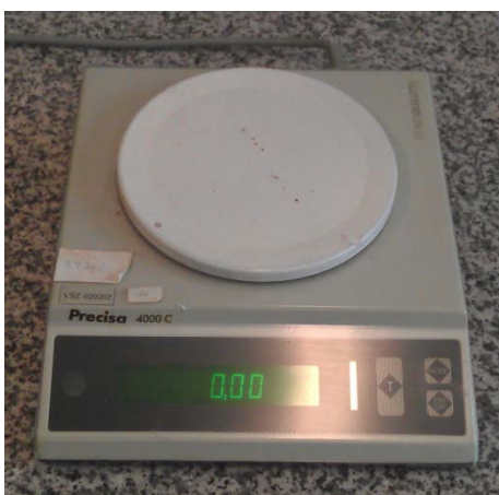
Obr. 7: Digitální váha Precisa 4000 C
