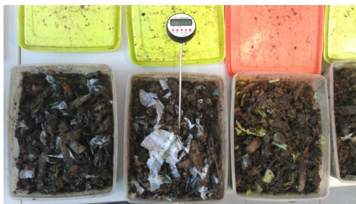
Fotodokumentace 2: Měření teploty zapichovacím teploměrem (Zdroj: autorka)
