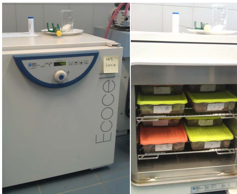
Obr. 13: Sušárna Ecocell a v ní vložené reaktory
