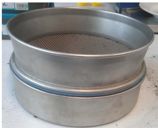
Obr. 17: Síto Retsch s velikostí otvorů 2 mm
