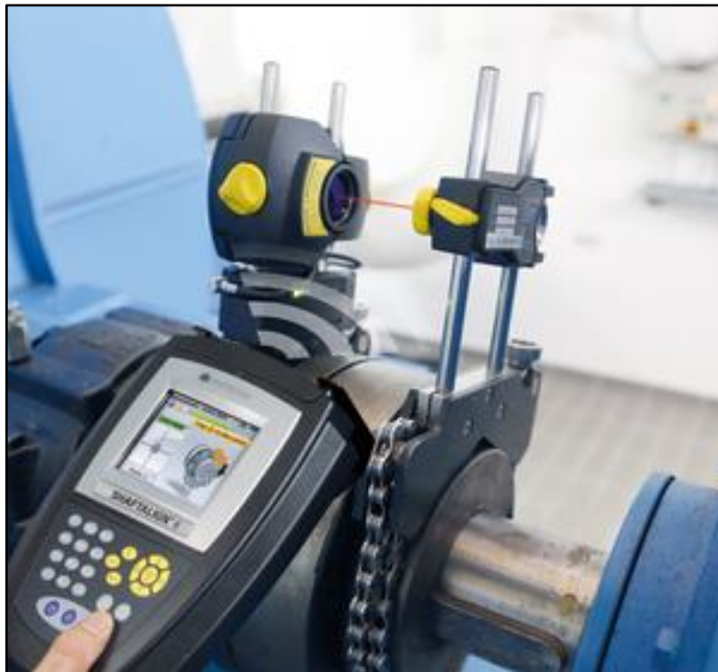
Obr. 11 Laserové ustavování v praxi [29]
