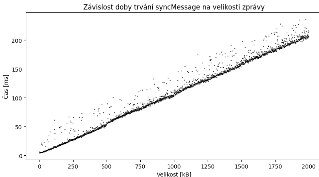
Obrázek 4.4: Výstup měření vlivu velikosti přenesených dat na dobu trvání syncMessage .
