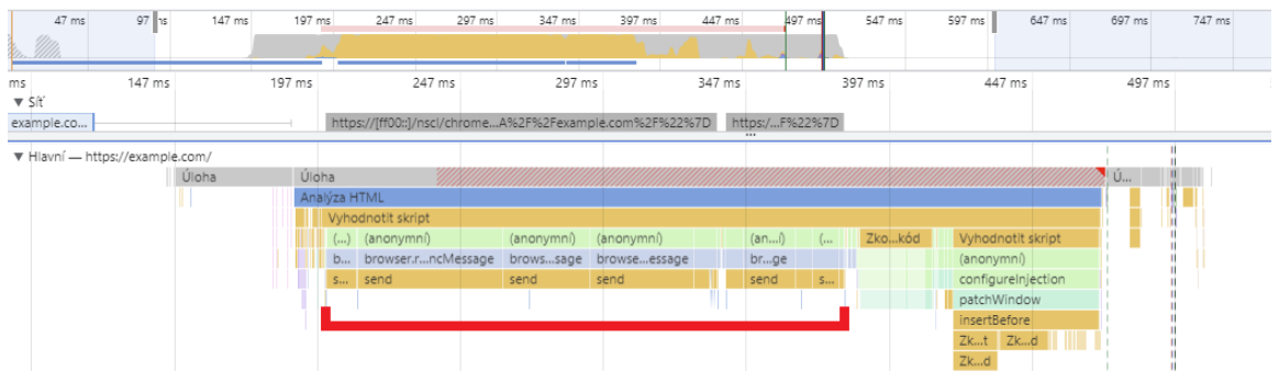
Obrázek 4.2: Výstup analýzy načtení jednoduché stránky, příklad pomalého načtení. Interval, ve kterém probíhá načtení konfigurace, je označen červeně.
