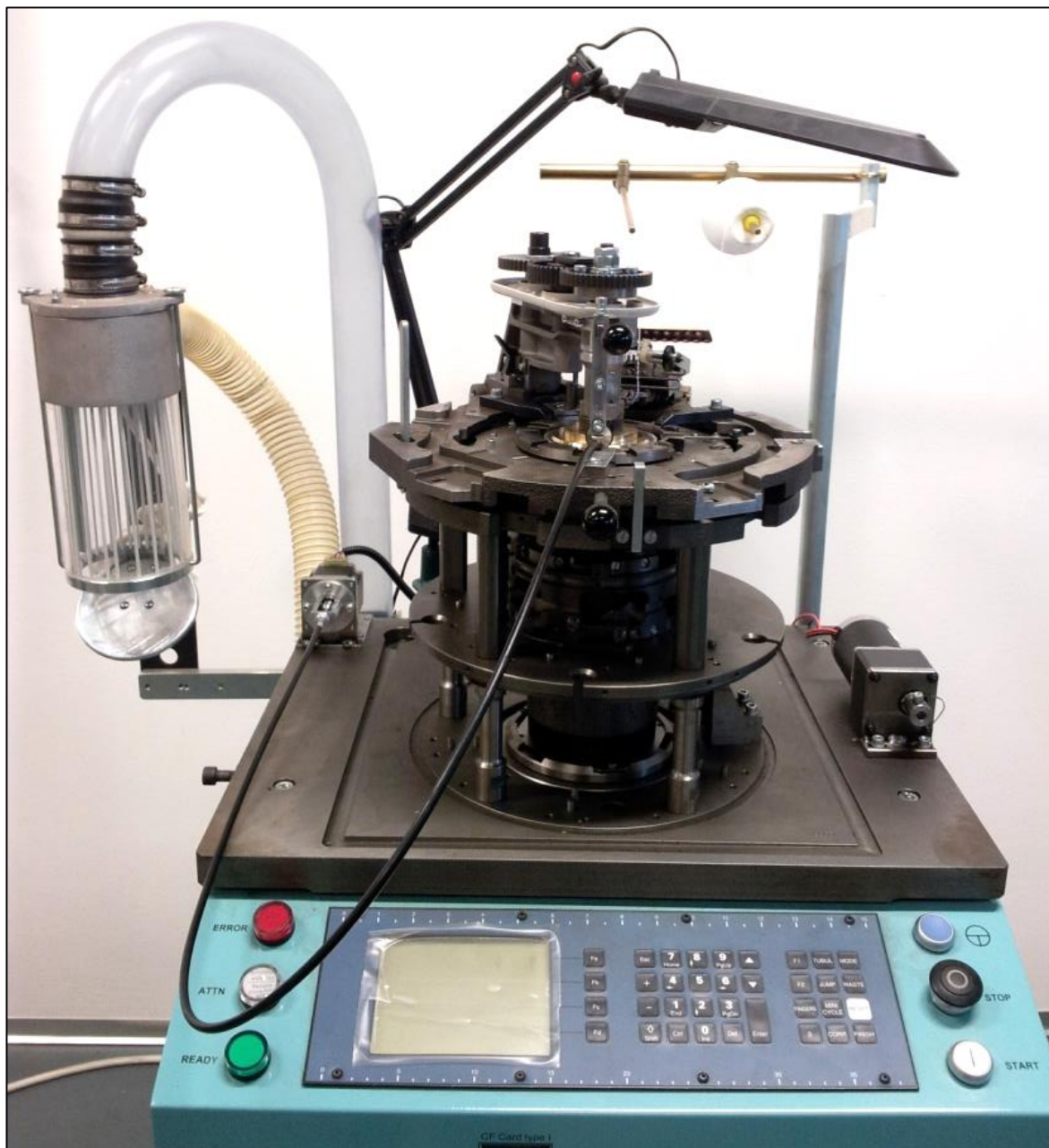
Obr. 5.41 Zástavba individuálního systému pohonu stříhacího kotouče do malopřůměrového pletacího stroje Ange 18.1.
