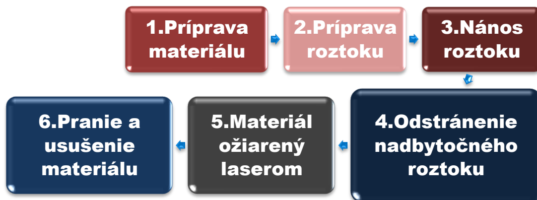
Obr. 21 Schematické znázornenie postupu farbenia
