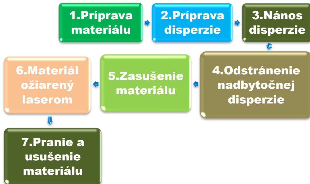
Obr. 23 Schematické znázornenie postupu farbenia
