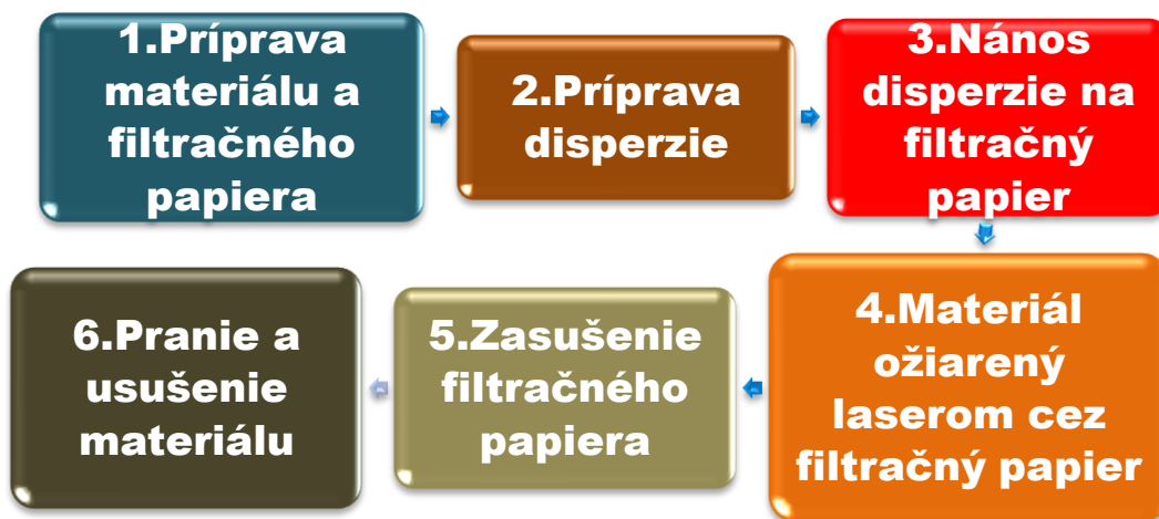
Obr. 27 Schematické znázornenie postupu farbenia
