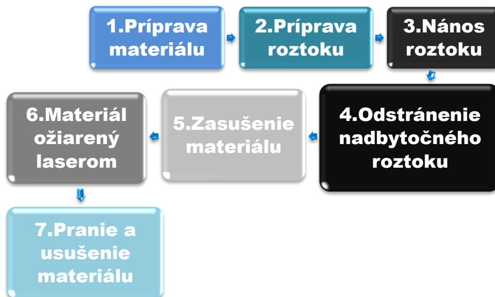
Obr. 22 Schematické znázornenie postupu farbenia
