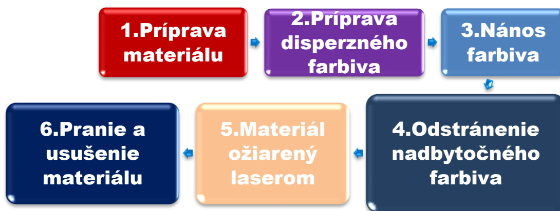
Obr. 24 Schematické znázornenie postupu farbenia
