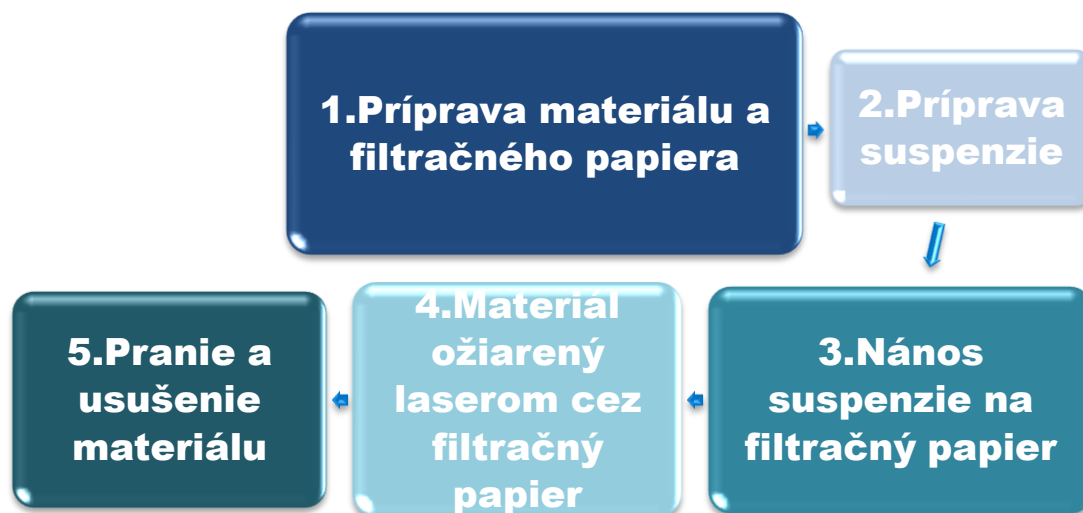
Obr. 26 Schematické znázornenie postupu farbenia
