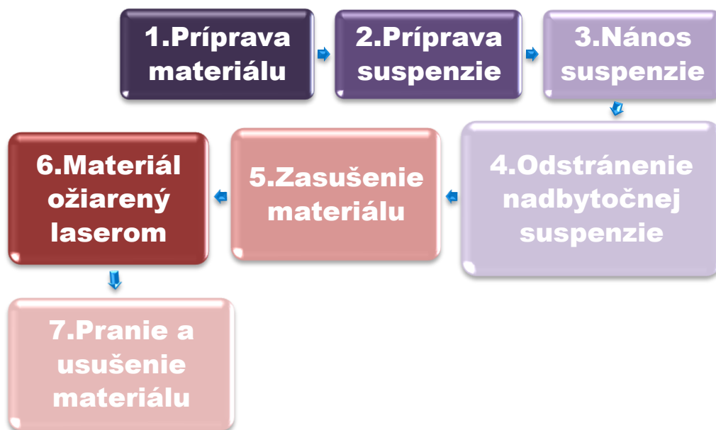
Obr. 25 Schematické znázornenie postupu farbenia
