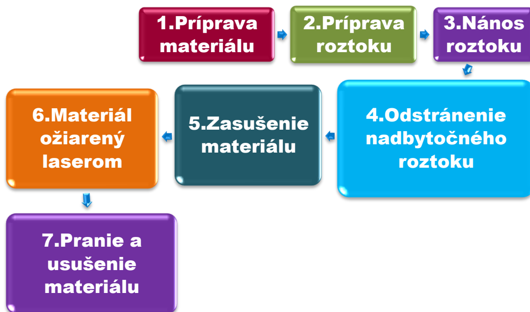
Obr. 20 Schematický postup farbenia
