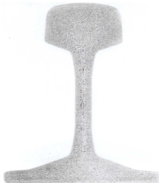
Obr. 2.2b Dvojitá pozitivní segregace ve stojině [14]
