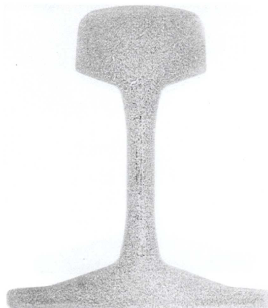
Obr. 2.2b Dvojitá pozitivní segregace ve stojině [14]
