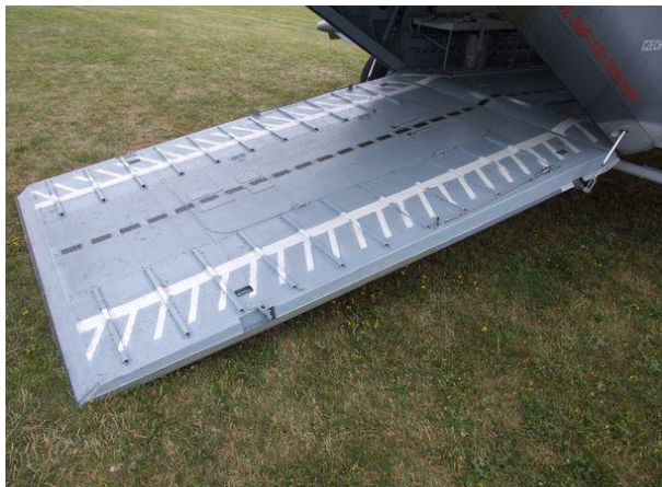
Obrázek 13: Nákladová rampa vrtulníku Mi-171 Š
