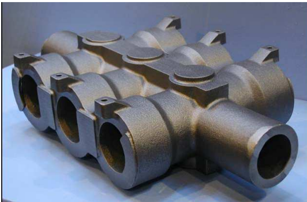
Obr. 2.6 Součást zhotovená pomocí keramické formy (228kg) (21)
