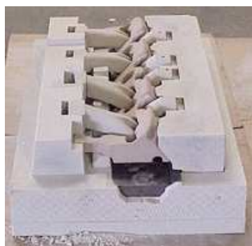
Obr. 2.10 forma zhotovená pomocí DSPC a příklad výrobku (22)
