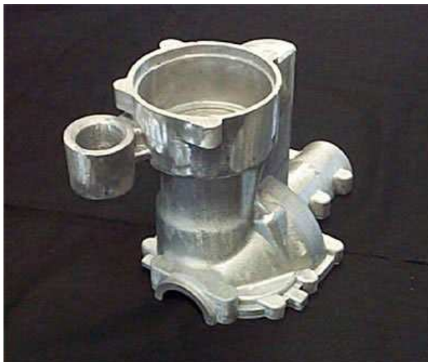
Obr. 2.9 příklad výrobku zhotoveného metodou ZCast (16)
