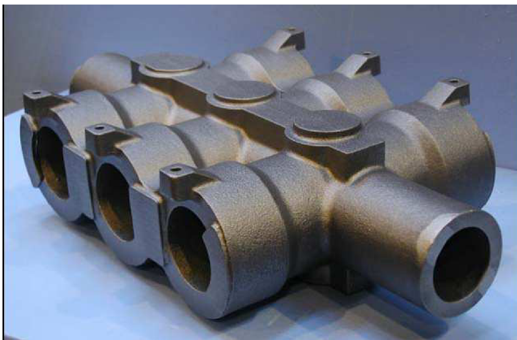
Obr. 2.6 Součást zhotovená pomocí keramické formy (228kg) (21)
