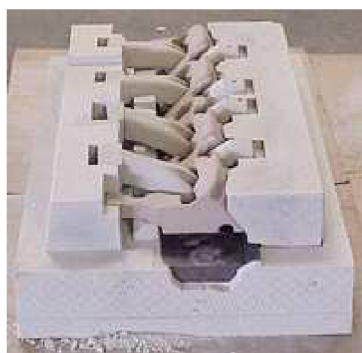
Obr. 2.10 forma zhotovená pomocí DSPC a příklad výrobku (22)
