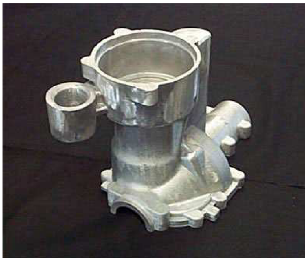
Obr. 2.9 příklad výrobku zhotoveného metodou ZCast (16)
