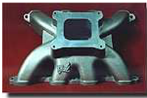
Obr. 2.10 forma zhotovená pomocí DSPC a příklad výrobku (22)
