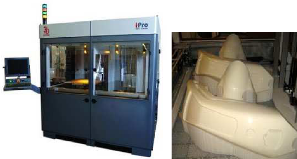
Obr. 1.4 stereolitografické centrum iPro 9000 XL s ukázkou konkrétního výrobku (6)
