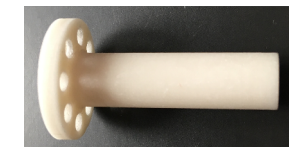
Držák termočláčku před spékáním
