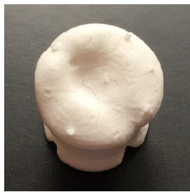
Model zubu po spékání bez podpor
