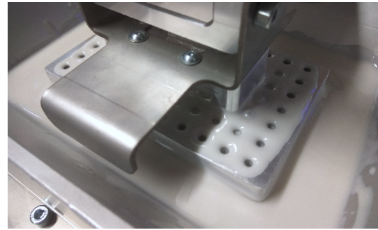
Platforma ponořena do polymeru
