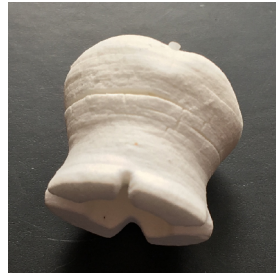
Model zubu po spékání bez podpor
