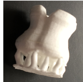
Model zubu po spékání s podporami
