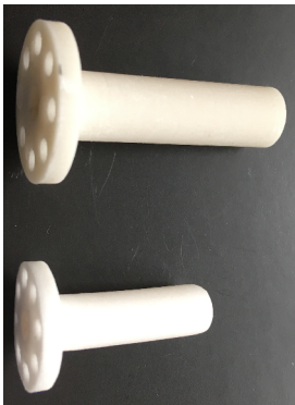
Držák termočláčku před a po spékání
