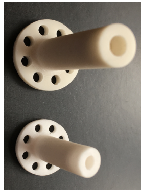
Držák termočláčku před a po spékání
