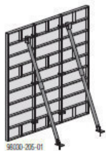
Obrázek 6. 1 - Sestavení první strany bednění [30]
