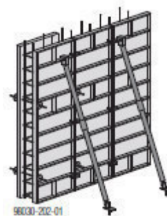
Obrázek 6. 2 - Sestavení druhé strany bednění [30]
