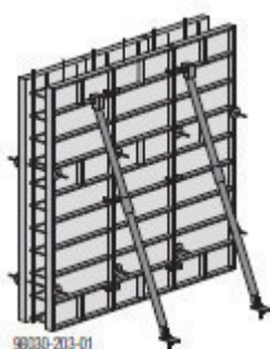
Obrázek 6. 3- Celá sestava bednění [30]
