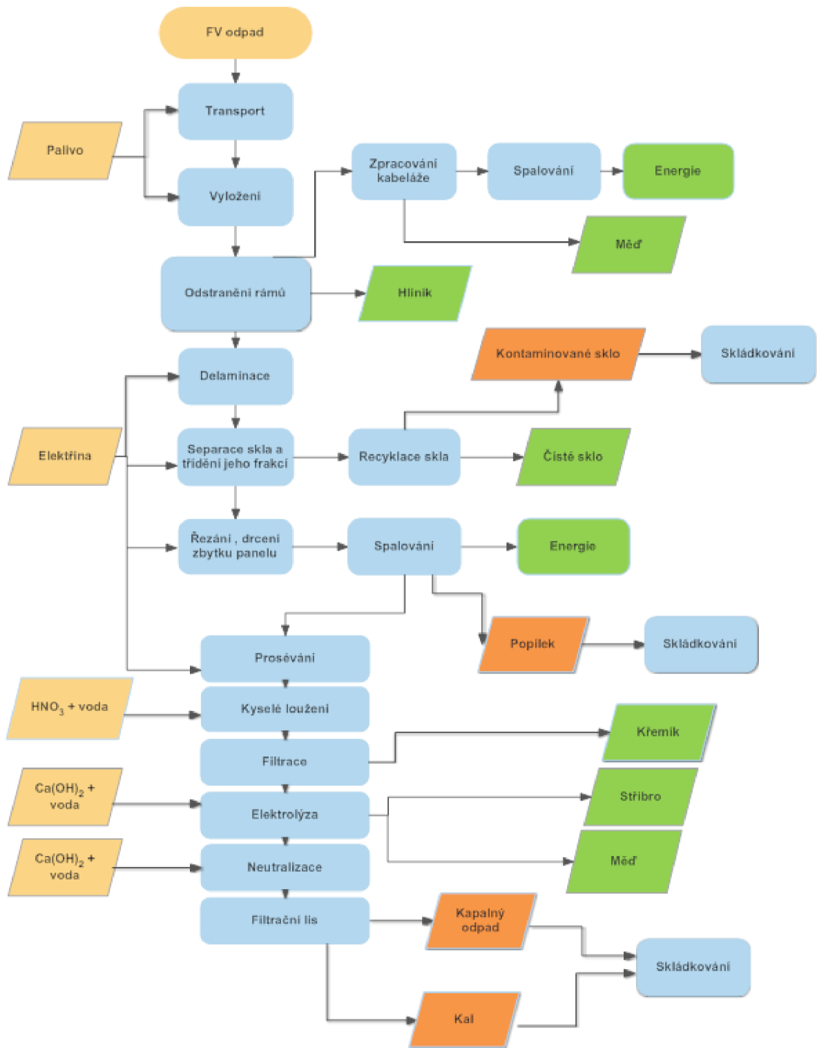
Obrázek 4.3: Schéma celé likvidace/recyklace FV panelů (dle FREL P procesu)
