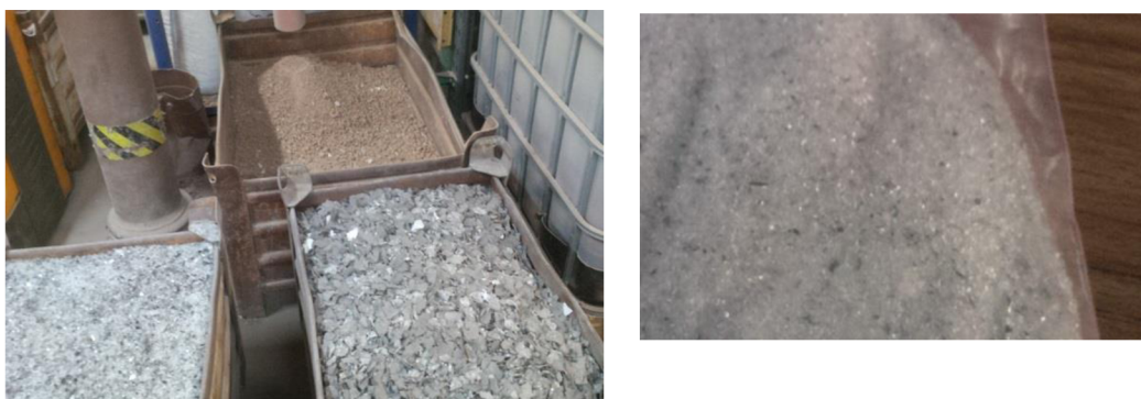
Obrázek 3.27: Na snímcích panely připravené k drcení, drtič materiálu, dělič frakcí drceného panelu a jednotlivé frakce FV odpadu ve firmě Bambas Elektro s.r.o (Zdroj: Archiv autora)
