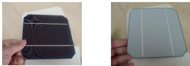
Obrázek 3.4: Přední a zadní strana monokrystalického křemíkového článku [4]
