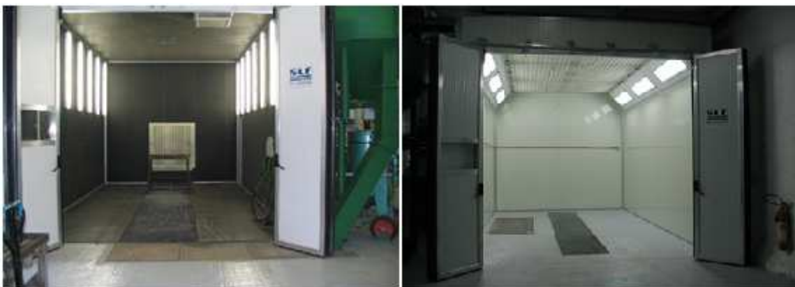
Obrázek 3 Tryskací kabina vlevo, lakovací kabina vpravo
