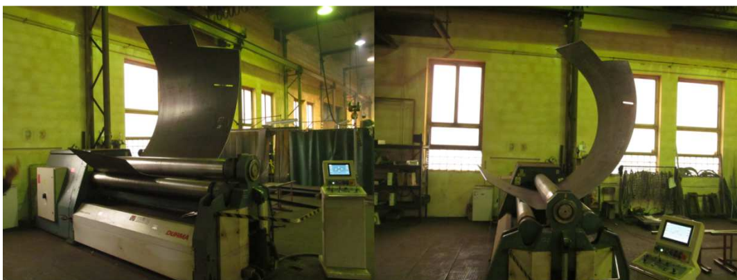
Obrázek 2 Zakružování pláště Solomixu
