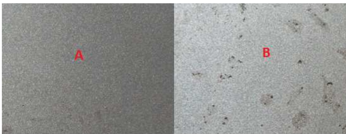
Obrázek 4 Detail brokovaného povrchu A - bezvadný povrch, B - povrch s vadami
