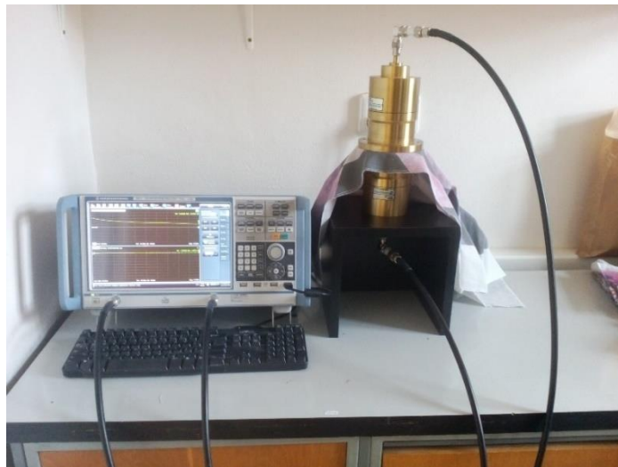
Obrázek 14 Měřicí soustava pro hodnocení elektromagnetické stínící účinnosti
