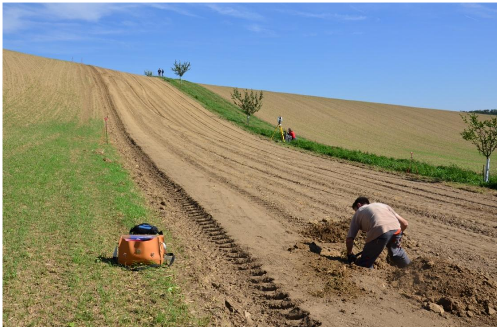
Obr. č. 14: Souběžné provádění terénních prací - kopání půdních sond (v popředí) a skenování LiDARem (v pozadí)
