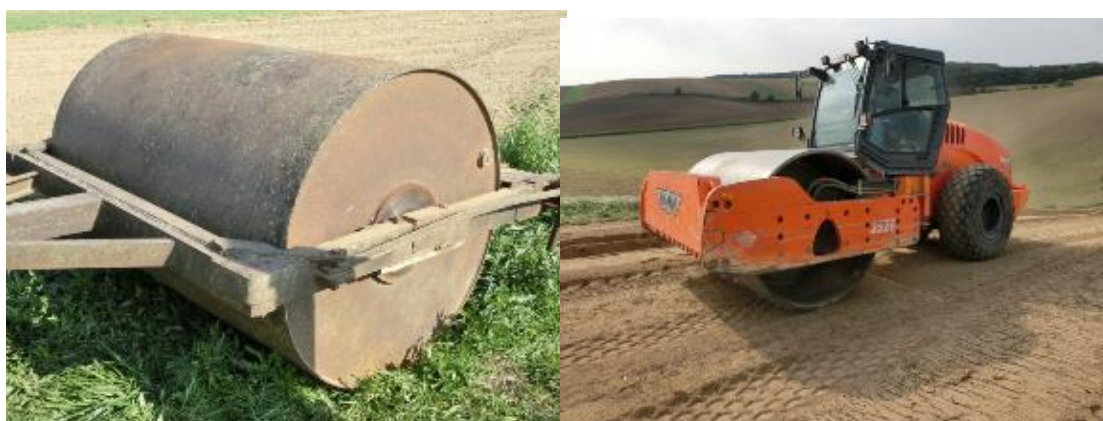
Obr. č. 19: Luční válec STS s náplní vody (vlevo), vibrační válec HAMM (vpravo)
