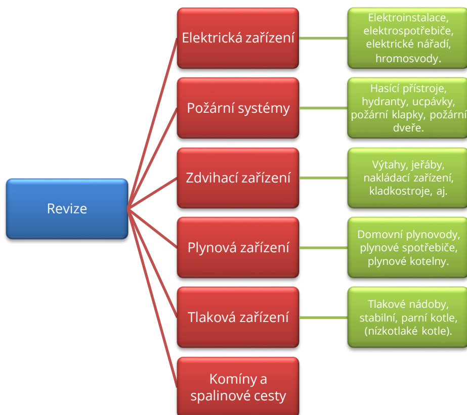
Obr. č. 8 - Rozdělení vyhrazeného technického zařízení [vlastní]
