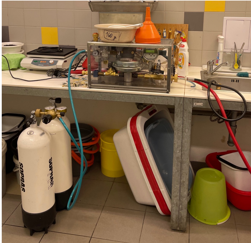
Obr. 15: Tlaková jednotka k indukci triploidie (foto: K. Trnka)
