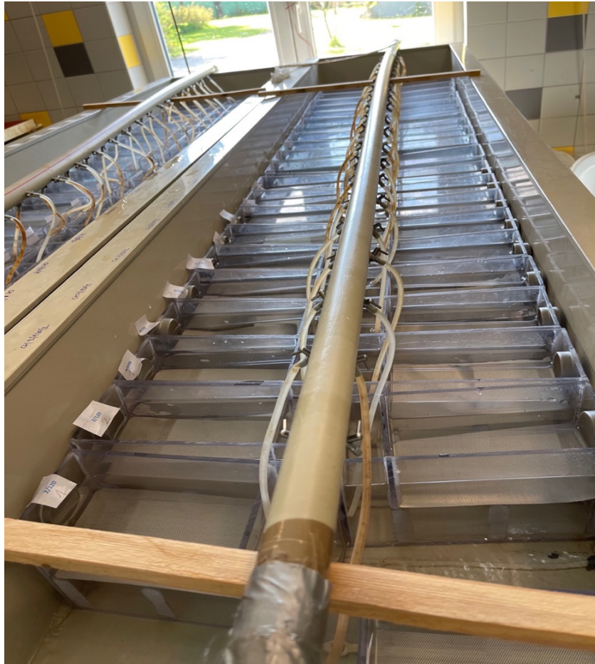
Obr. 10: Průtočný systém s inkubačními aparáty (foto: K. Trnka)
