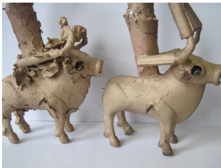
Obr. 20 Porovnání odlitku z hliněné formy (vlevo) a keramické skořepiny (vpravo)
