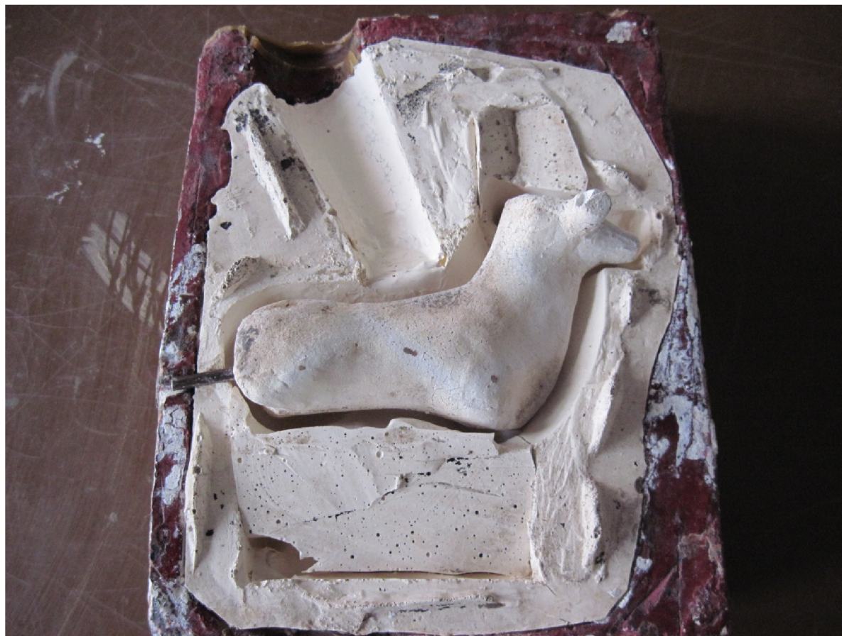
Obr. 11 Sádrový model umístěný v lukoprenové formě
