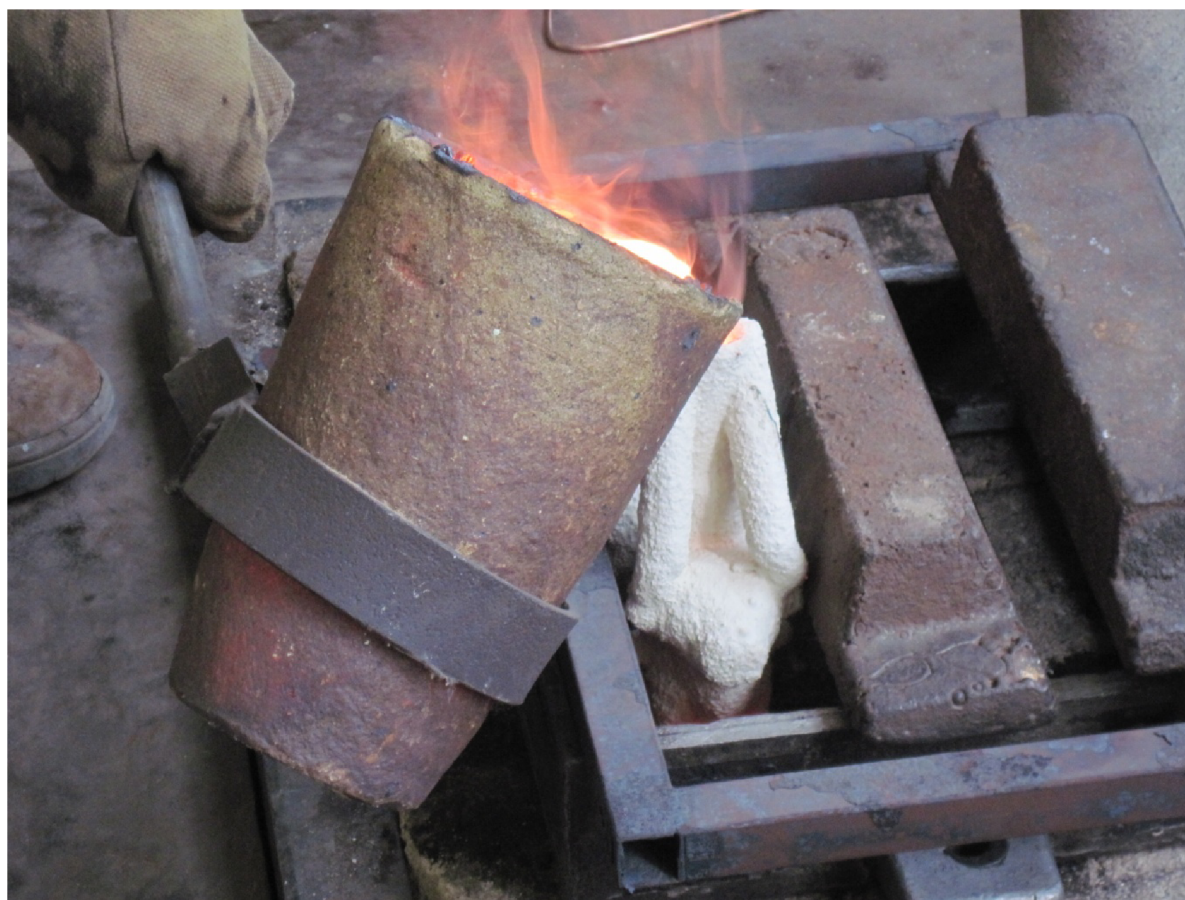
Obr. 16 Lití bronzu do skořepinové formy
