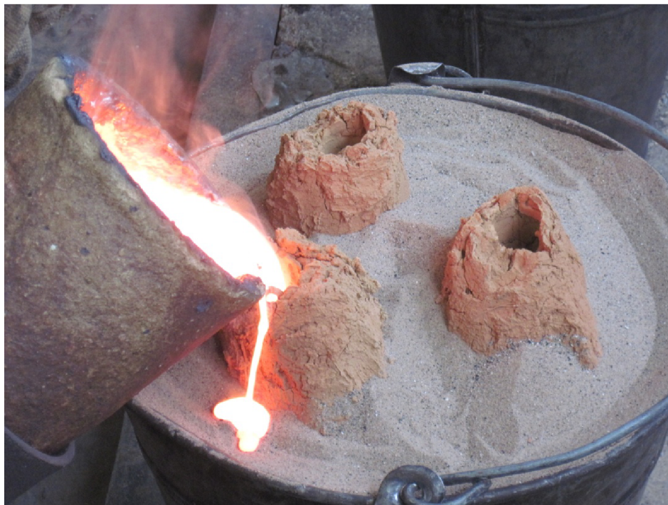
Obr. 17 Odlévání kovu do hliněné formy
