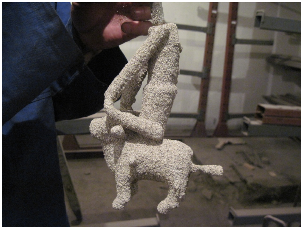
Obr. 12 Voskový model s nanesenou první vrstvou písku
