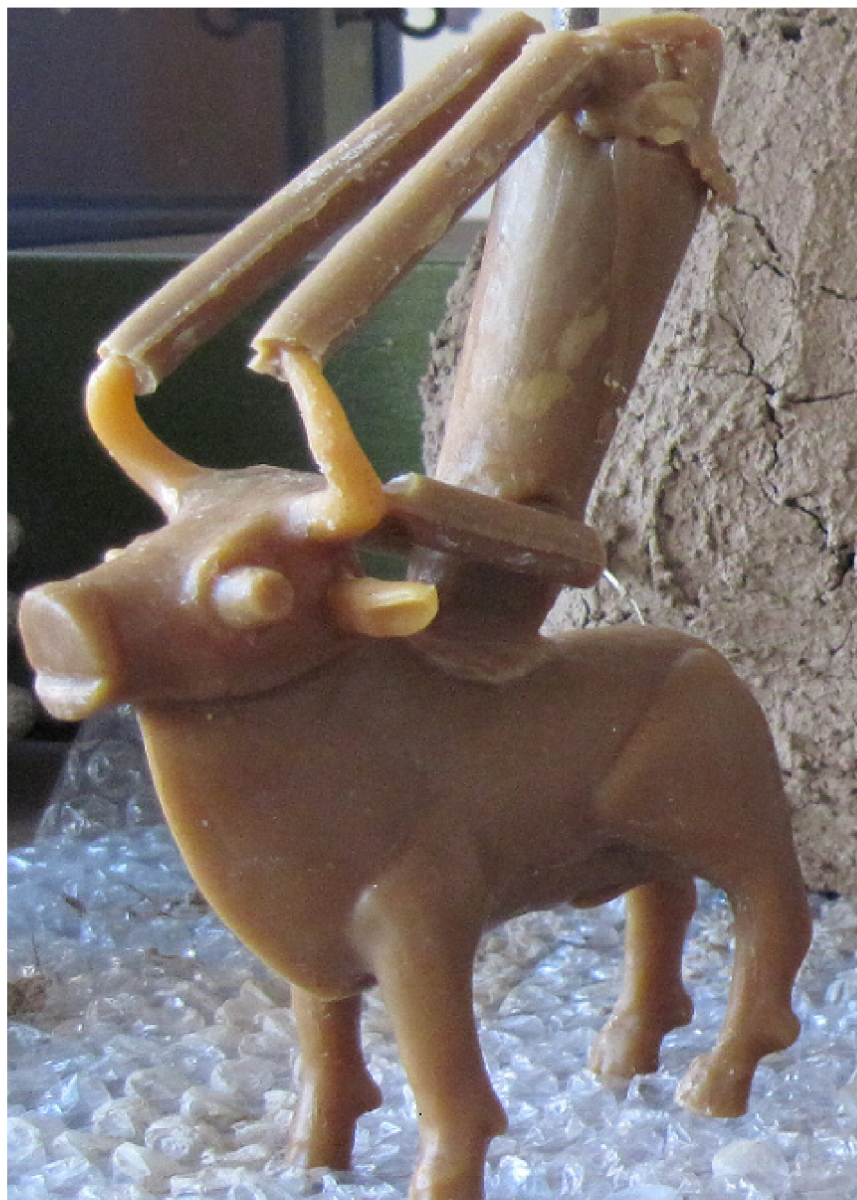
Obr. 8 Voskový model býčka s napájenou vtokovou soustavou
