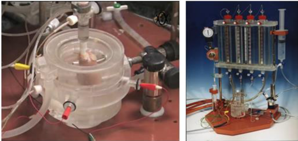
Obrázek 10.2: Vlevo - vanička s izolovaným srdcem; vpravo - perfusní systém.
