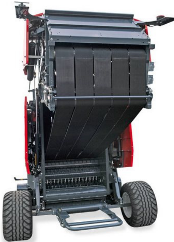
Obr. 4.5: Variabilní lisovací komora s nekonečnými pásy v pěti řadách lisu Varioprofi fy Pöttinger [24].
