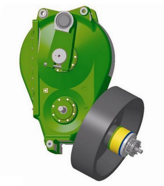
Obr. 3.17: Převodovka, setrvačnick, volnoběžná spojka lisů BiG Pack fy KRONE [18].
