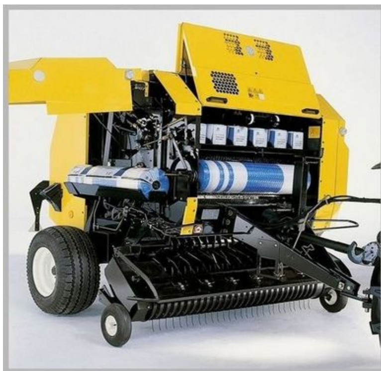
Obr. 4.11: Uskladnění motouzů a sítě lisu BR 6000 fy New Holland [17].
