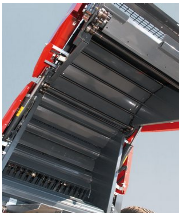
Obr. 4.8: Kovové válce v pevné lisovací komoře lisu Rollprofi fy Pöttinger [24].
