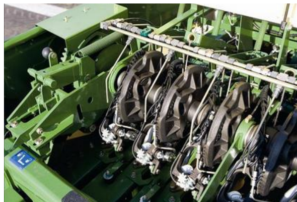
Obr. 3.27: Dvojité uzlovače lisu KRONE BP 1290 [18].
