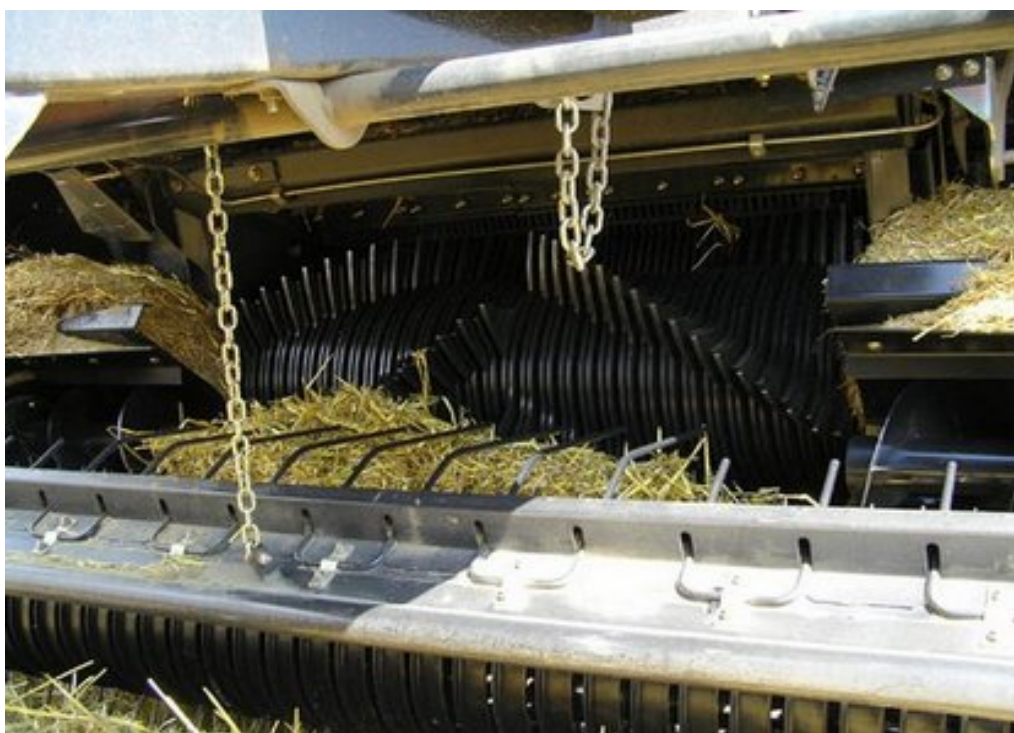
Obr. 3.9: Šnekové dopravníky před vstupem do řezacího ústrojí u lisu Case LBX 422 [4].
