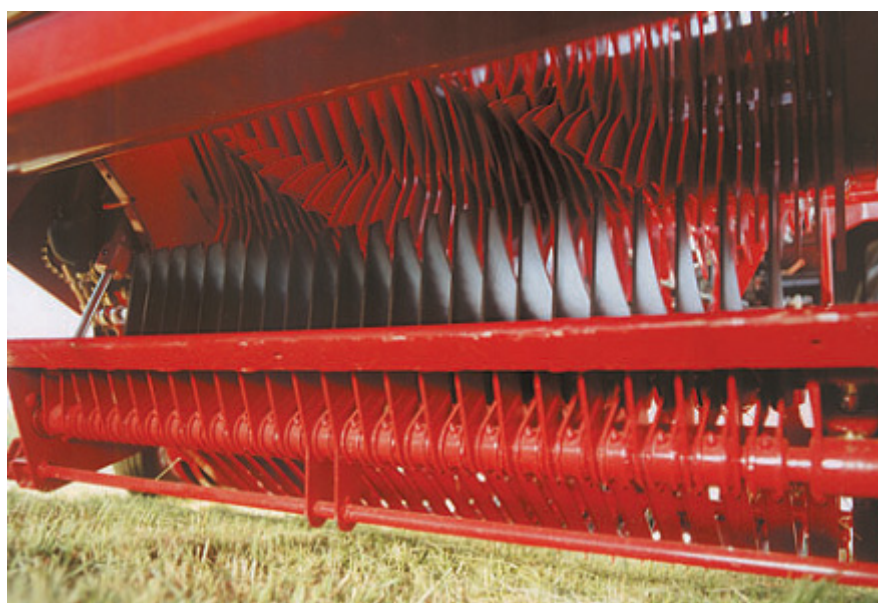
Obr. 3.14: Výklopný rám s noži u lisu D 4060 fy Welger [22].
