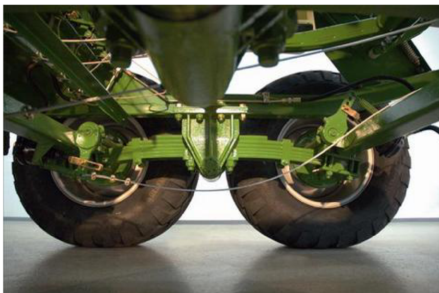
Obr. 3.28: Pevná tandemová náprava (boogie) lisu KRONE BiG Pack 1290 [18].
