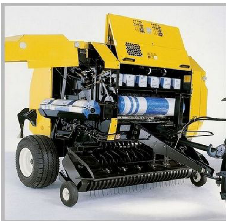
Obr. 4.11: Uskladnění motouzů a sítě lisu BR 6000 fy New Holland [17].
