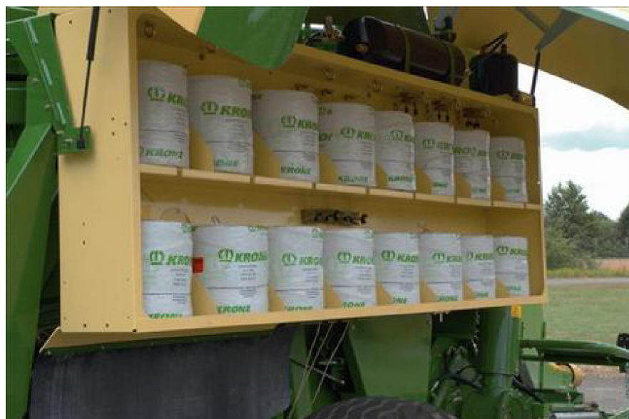
Obr. 3.30: Schránka pro motouzy lisů KRONE Bick Pack [18].
