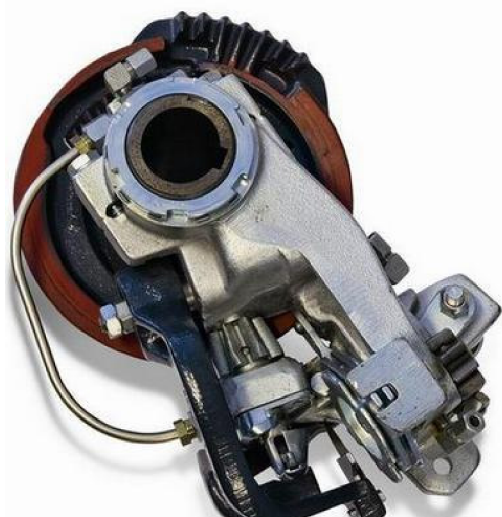
Obr. 3.24: Uzlovač Deering u lisů KRONE BP [18].
