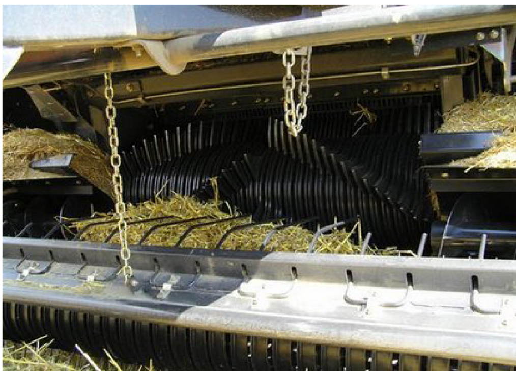
Obr. 3.9: Šnekové dopravníky před vstupem do řezacího ústrojí u lisu Case LBX 422 [4].
