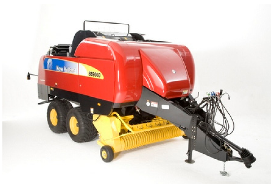
Obr. 2.2: Lis na velké hranolovité balíky New Holland BB 9060 [17].
