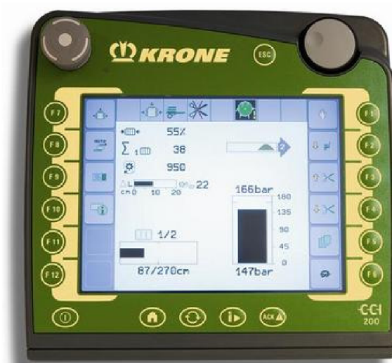
Obr. 3.20: Řídicí jednotka KRONE [18].
