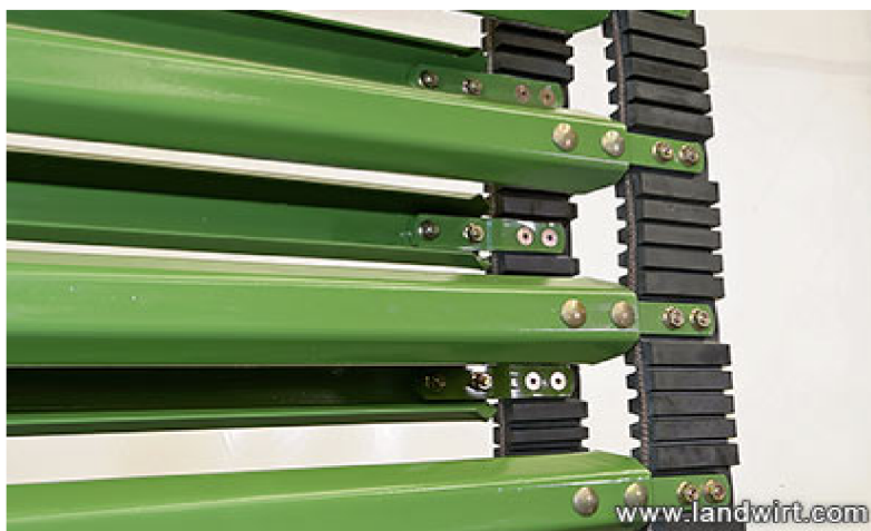
Obr. 4.9: Příčkový dopravník NovoGrip fy KRONE v lisech Comprima [18].
