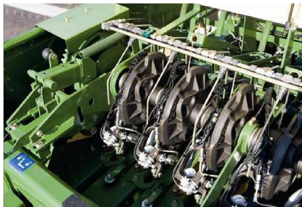
Obr. 3.27: Dvojité uzlovače lisu KRONE BP 1290 [18].
