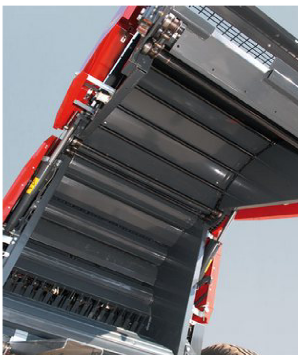
Obr. 4.8: Kovové válce v pevné lisovací komoře lisu Rollprofi fy Pöttinger [24].
