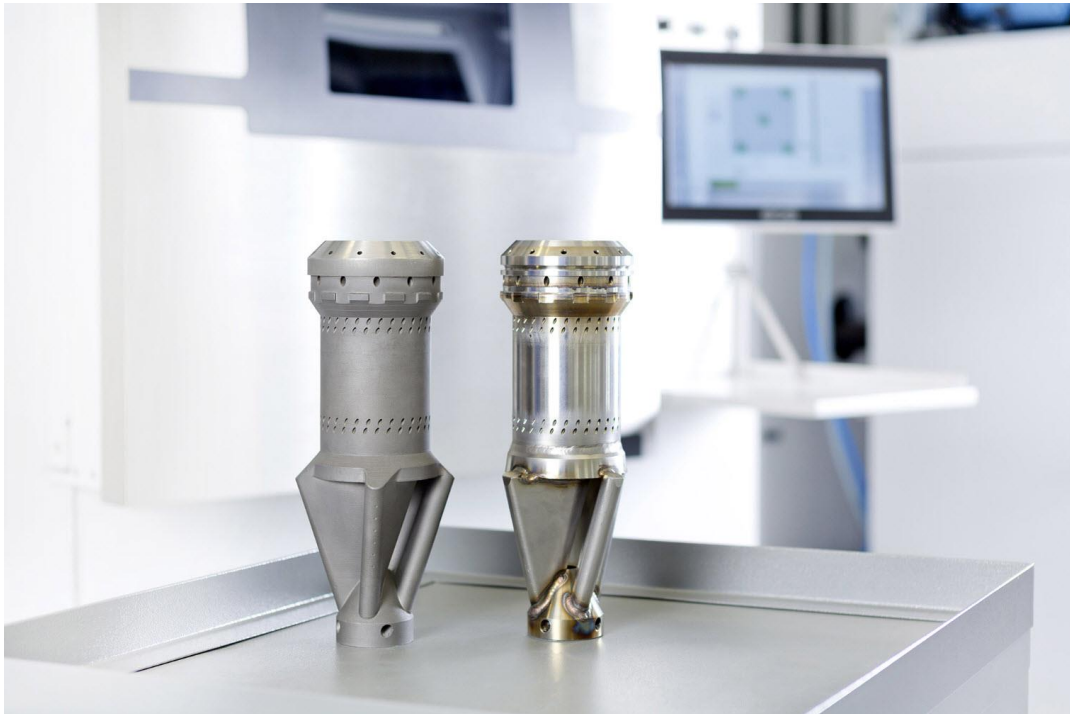
Obrázek 18: Porovnání hořáků vyrobených 3D tiskem (vlevo) a tradičním způsobem (vpravo) [33]
