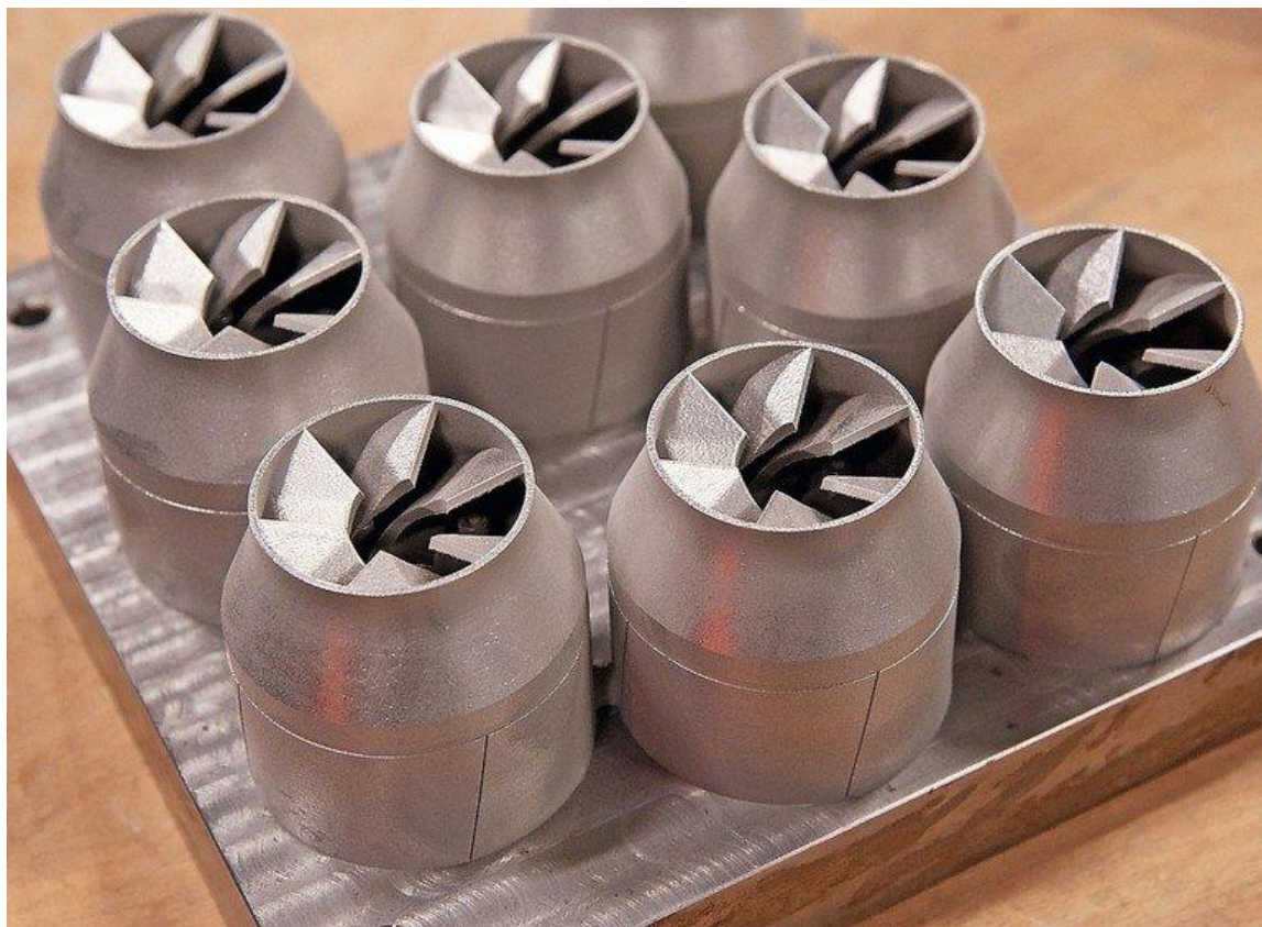
Obrázek 19: Hořáky vyrobené v Brně pomocí 3D tisku [31]
