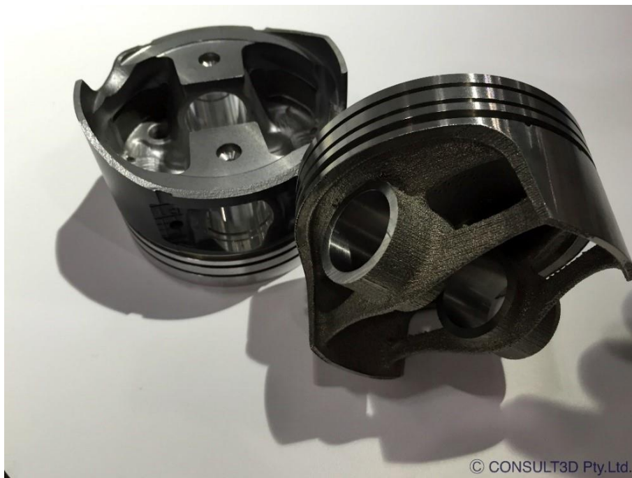
Obrázek 11: Píst vyrobený pomocí EBM [16]
