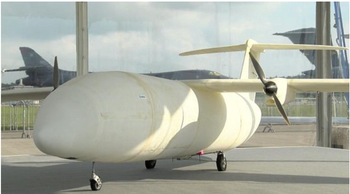
Obrázek 1: První letadlo vyrobené pomocí 3d tisku [11]
