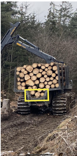
Obrázek č. 8 - Prostor přičítaný ve výpočtu velikosti nákladu
