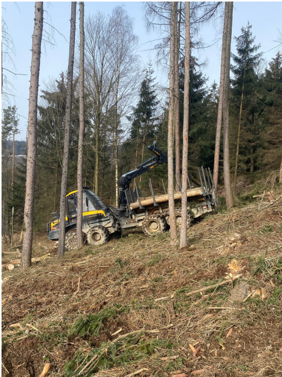
Obrázek č. 5 - Vyvážecí traktor Ponsse Buffalo při sestavování nákladu (VLASTNÍ)
