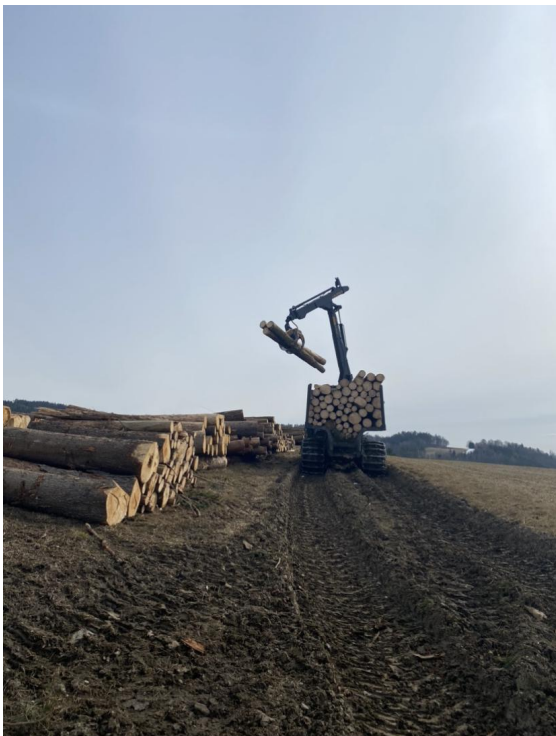
Obrázek č. 7 - Skládání nákladu na OM vyvážecím traktorem Ponsse Buffalo (VLASTNÍ)
