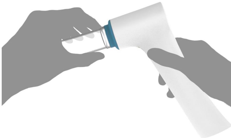
Obr. 6-11 Ergonomie náustku, odpojení dýchátka
