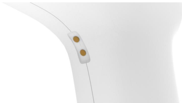
Obr. 6-8 Nabíjení, piny na náustku
