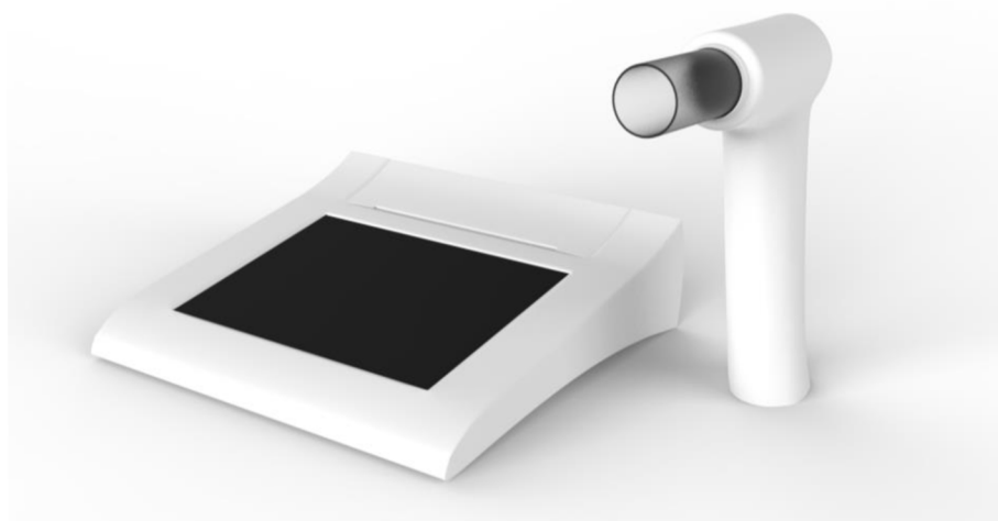
Obr. 4-5 Varianta I – řešení vyhodnocovací jednotky a náustku
