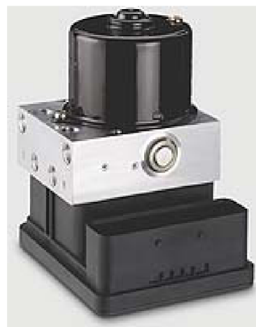
Obr. 15 Hydraulický brzdový asistent [16]
