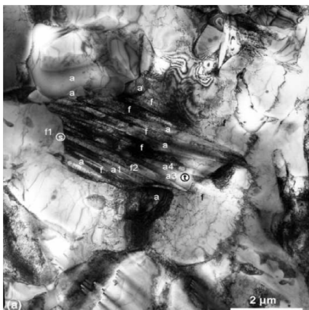
Obr. 4.14 TEM mikrosnímek lamely bainitu (nebo též bainitického feritu) [8].
