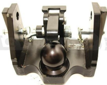
Obr.10 – Závěs traktoru s tažnou koulí K80 [16]
