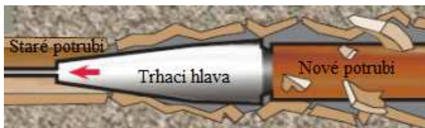
Obr. 7.11 Berstlining – trhání potrubí (upraveno z [34])
