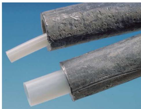
Obr. 7.10 Technologie Neofit. Shora: PET trubička po zatažení, vytvrzená vložka [4]
