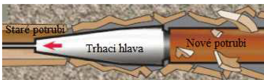
Obr. 7.11 Berstlining – trhání potrubí (upraveno z [34])
