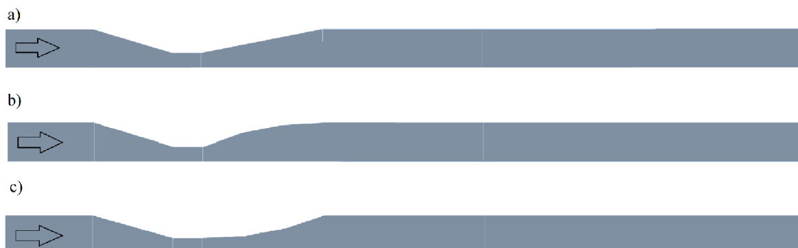
Obr. 3.2 Geometria troch vytvorených modelov Venturiho dýzy s vyznačeným smerom prúdenia. a) originálny tvar reálnej Venturiho dýzy v axisymetrickom zobrazení, b) model s konvexným tvarom výstupného difúzoru (konvexná stena vytvorená ako časť kružnice dotýčnej na stenu výstupného potrubia), c) model v konkávnom tvarom výstupného difúzoru (konkávná stena vytvorená ako časť kružnice dotýčnej na stenu hrdla dýzy).
