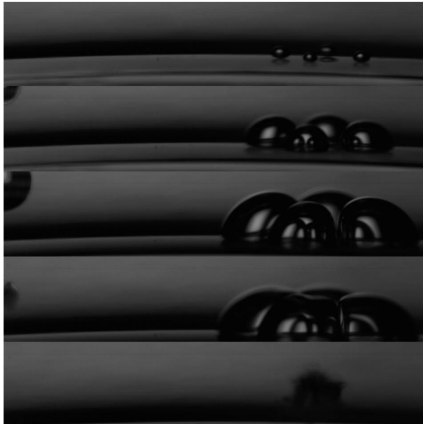
Obr.2.3 Vznik a následný kolaps kavitačných bublín na dne sklenenej nádoby. Pokles tlaku ktorý viedol ku kavitácii, bol v tomto prípade výsledkom akcelerácie po prudkom údere do nádoby vo vertikálnom smere. [11]
