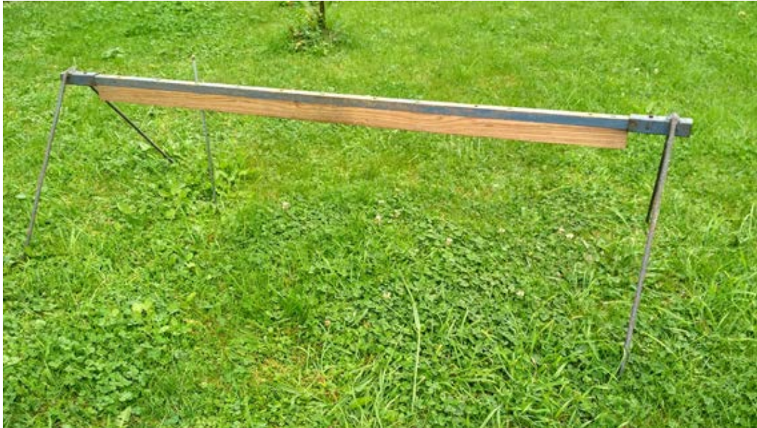
obr. č. 6: Použité měřidlo pro metodu přímého dotyku
