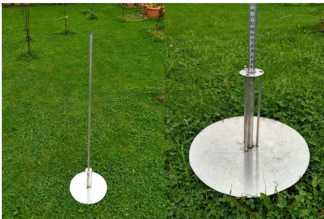
obr. č. 5: Použité mechanické talířové měřidlo
