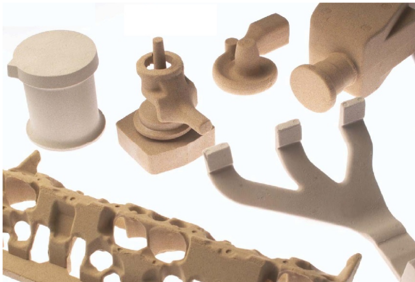
Obr. 15 Ukázka jader s pojivem GMBOND ® [25].
