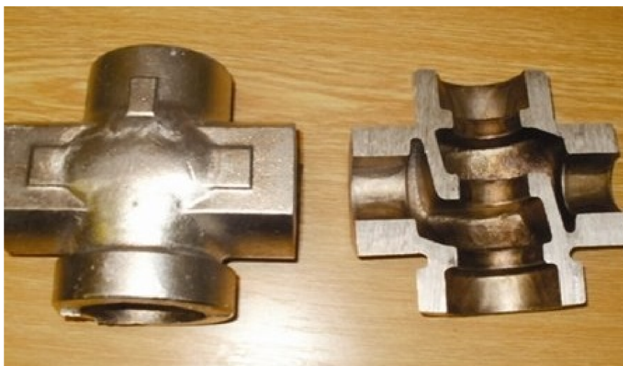
Obr. 19 Řez odlitkem z hliníkové slitiny [28].
