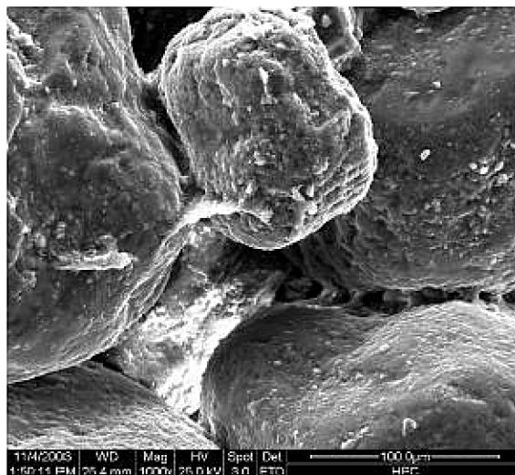
Obr. 12 Distribuce pojiva při použití vysokosmykového míchání [22].
