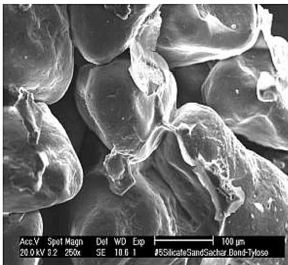
Obr. 11 Distribuce pojiva při použití lopatkového mísiče [22].
